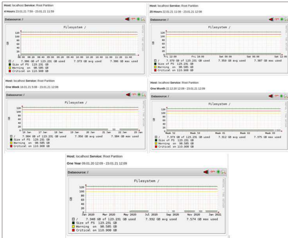
Ilustración 102 Reporte "Localhost - Particiones" NP4Nagios en: 4 horas, 25 horas, una semana, un mes, un año.
