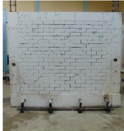
Fisuras finales en cara solaqueada y cara vista del muro 1
