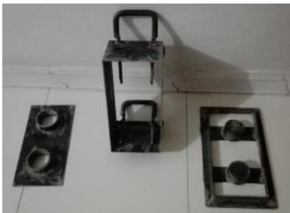
**Figura 60** Tipo del molde para los ladrillos
