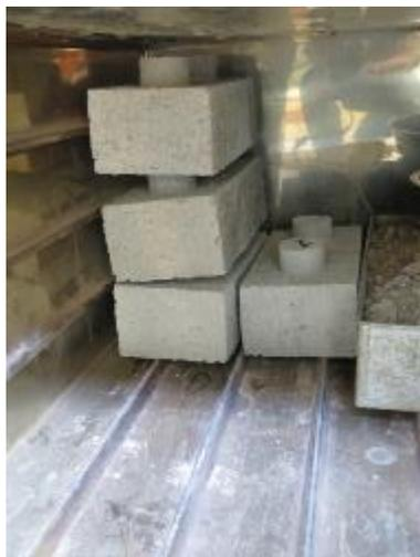
Secado de ladrillos en horno
