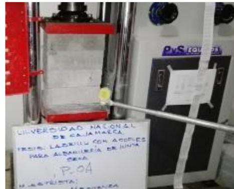
Carga y desplazamiento en pila 4
