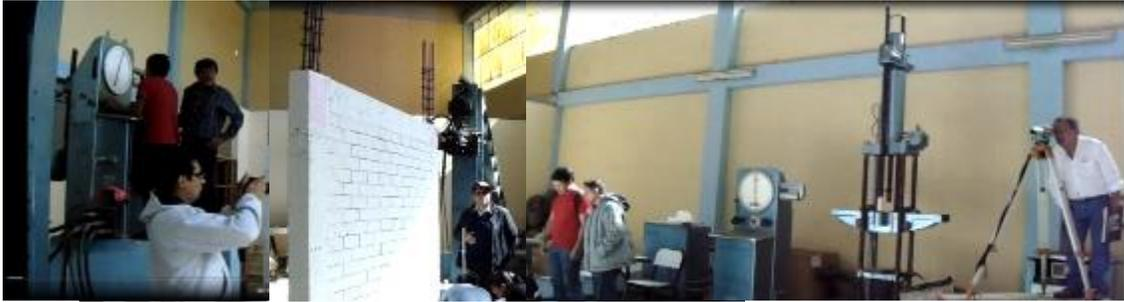
Ensayo de carga lateral monotónica (empuje) en muro 1
