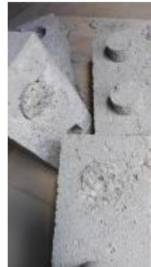
**Figura 82** Ensayo de resistencia al corte en tripletes
