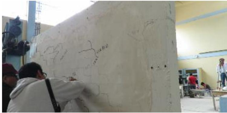
Ensayo de carga lateral (carga y descarga ) en muro 2
