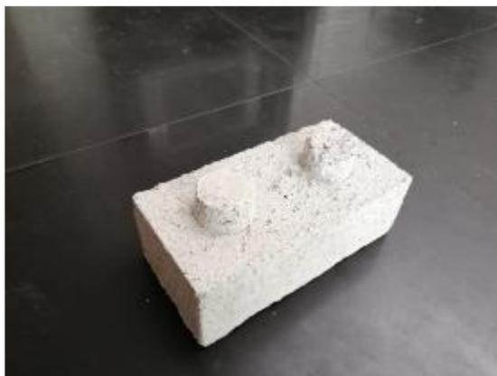
**Figura 61.** Prototipo de las unidades de albañilería
