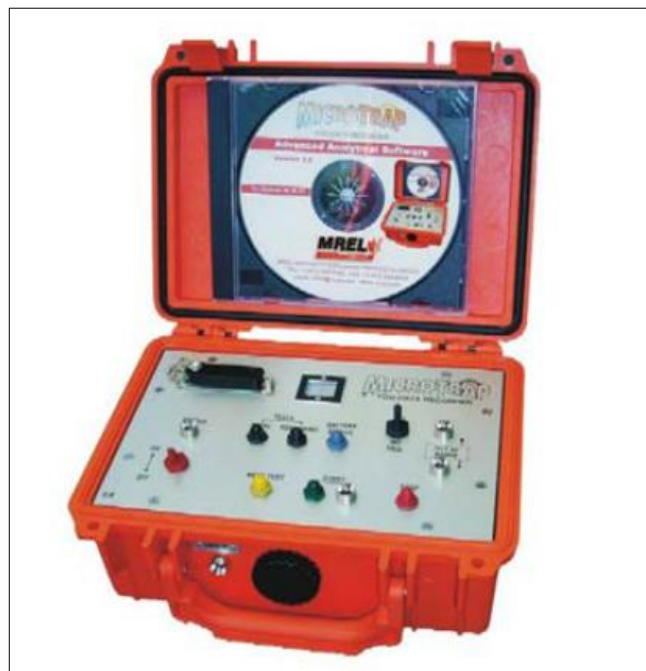
Figura 9: Equipo de medida continua de la velocidad de detonación. (Bernaola, Castilla, & Herrera, 2013)
