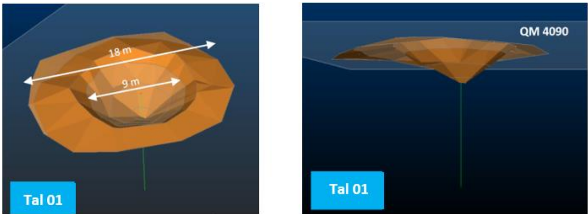
Figura 63: Perfil de esponjamiento y rotura del Taladro 1 – Prueba Tipo Cráter Nivel 4090
