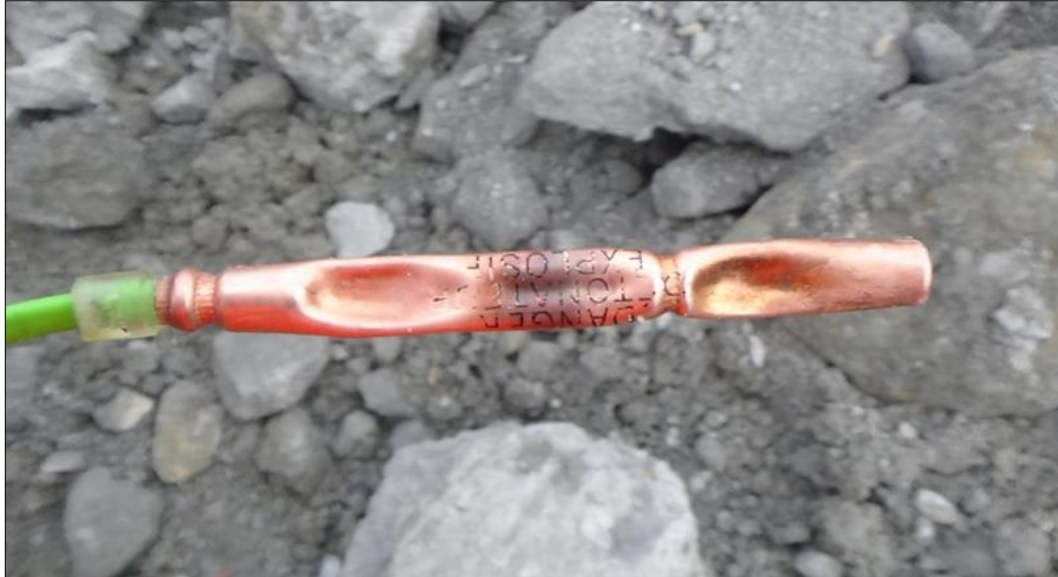
Figura 1: Fulminante electrónico con aplastamiento lateral debido a efectos de presión dinámica. (Dyno Nobel, 2017)
