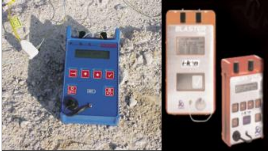
Figura 30: Programador de Retardos – Iniciador de alta seguridad. (Bernaola, Castilla, & Herrera, 2013)
