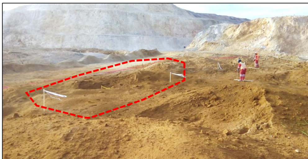
Foto 3: Posición de los taladros extras replanteados por topografía post voladura
