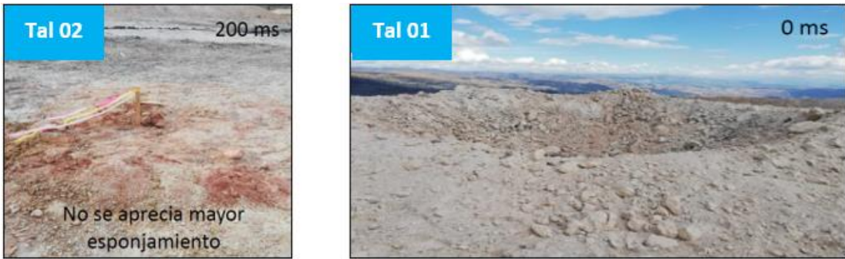
Figura 62: Resultados en campo de la prueba Tipo Cráter Nivel 4090 del Tajo Quecher
