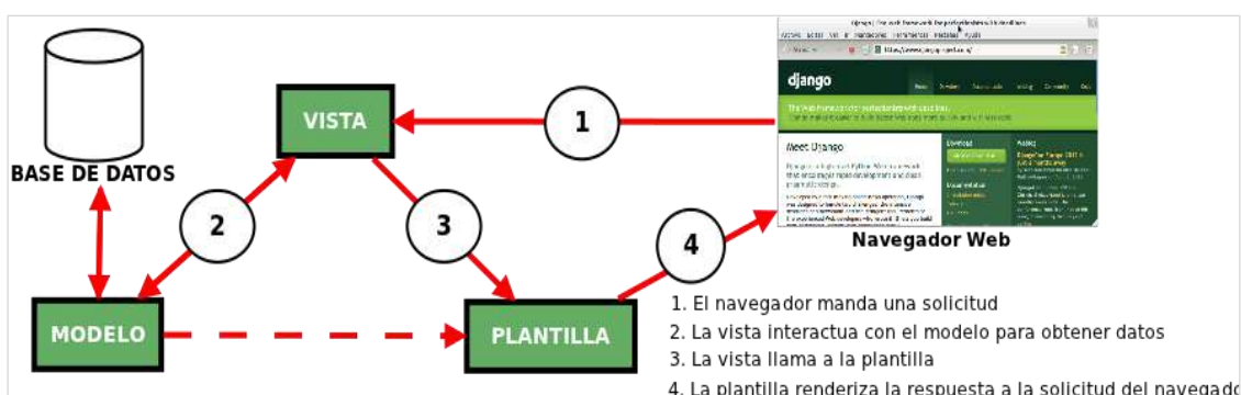
Figura 14: Funcionamiento del patrón MTV de Django
