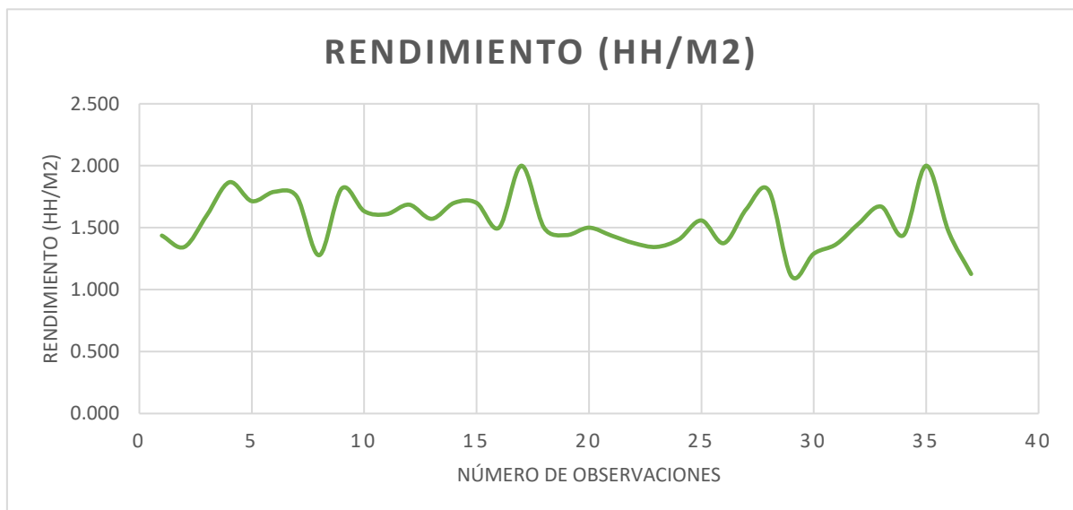
Figura 24: Distribución del rendimiento concreto armado en muros de ladrillo
