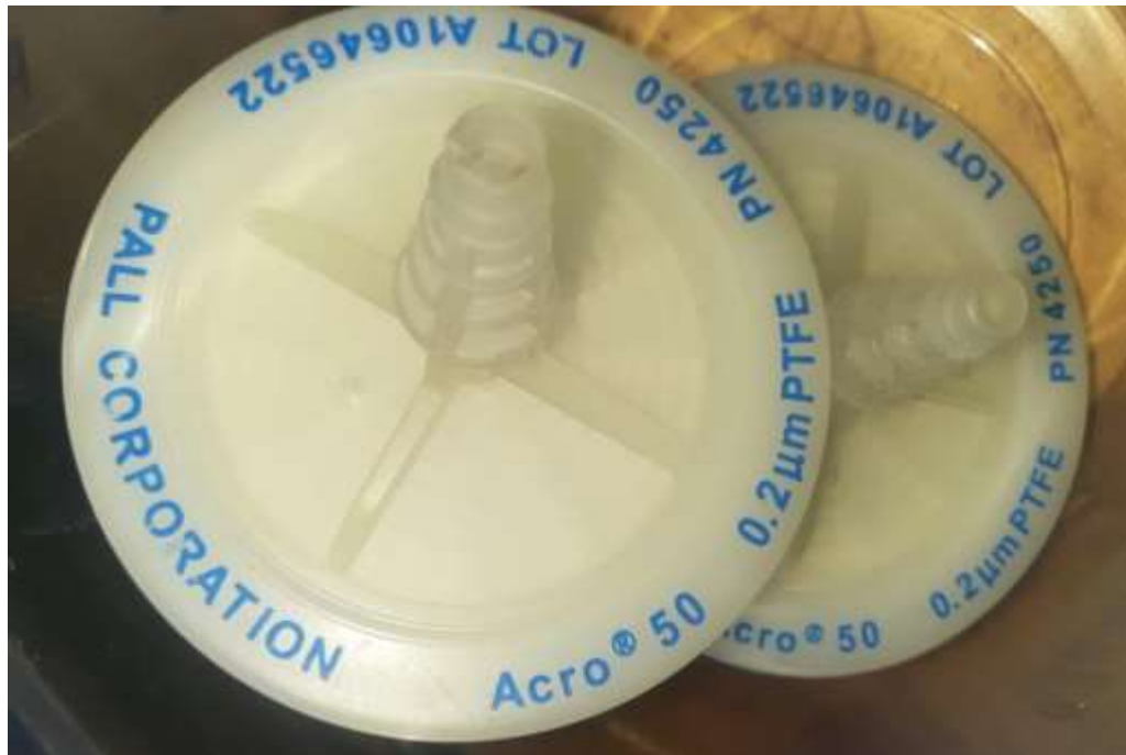
Figura 56. Filtros de venteo Acro ® 50 de 0,2 µm politetrafluoroetileno (PTFE).
