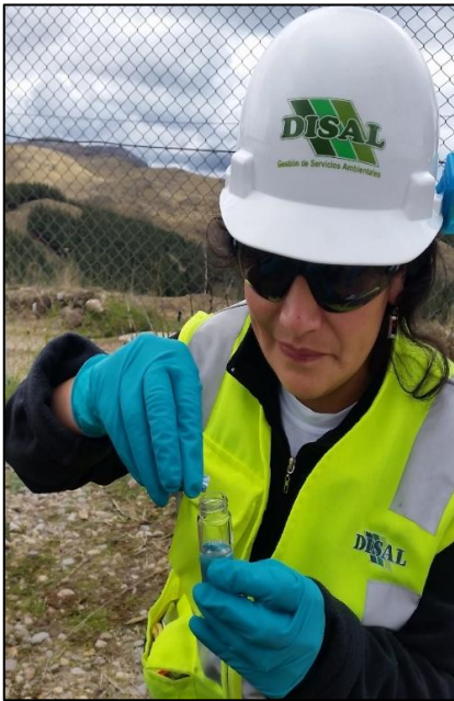
Figura 11. Agregando reactivo DPD a la muestra de agua.
