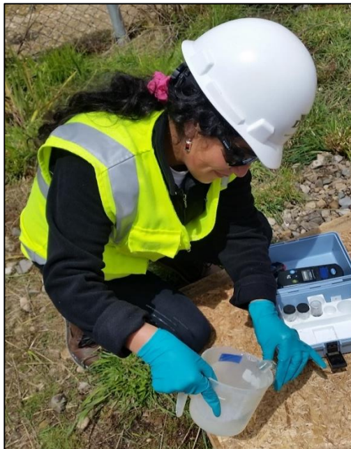
Figura 10. Cubeta con muestra de agua para el análisis de cloro residual.
