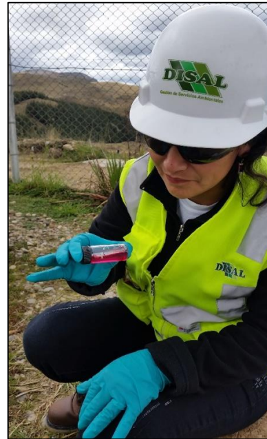
Figura 12. Agitación de muestra con reactivo DPD.
