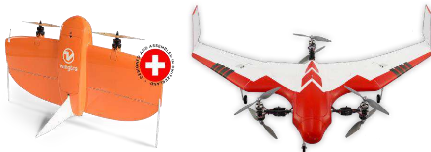
Figura 14. Drones mixtos (multirrotor - ala fija)
