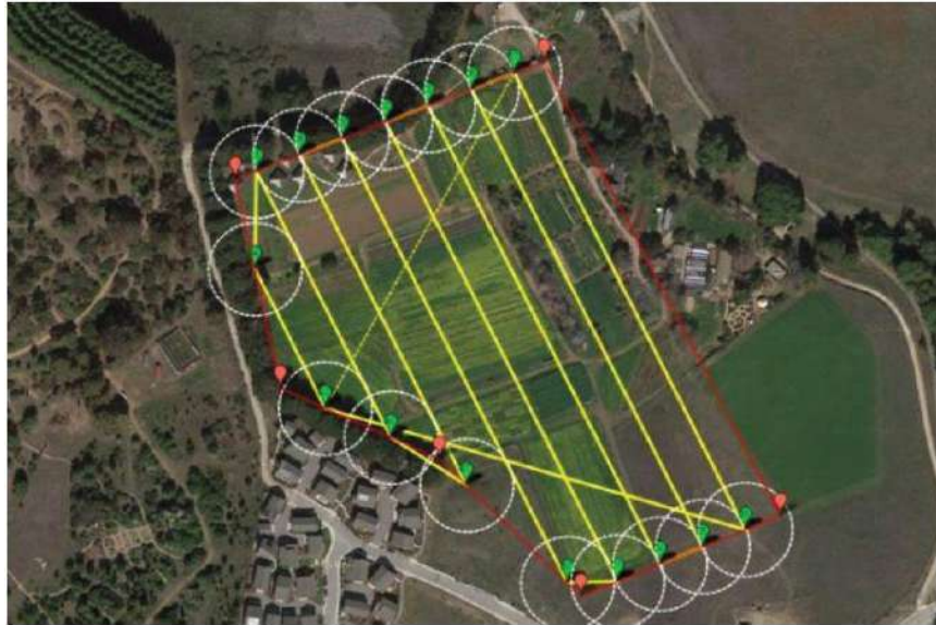
Figura 21. Trazado de plan de vuelo sobre un terreno (en rojo el perímetro, en verde el recorrido del dron).
