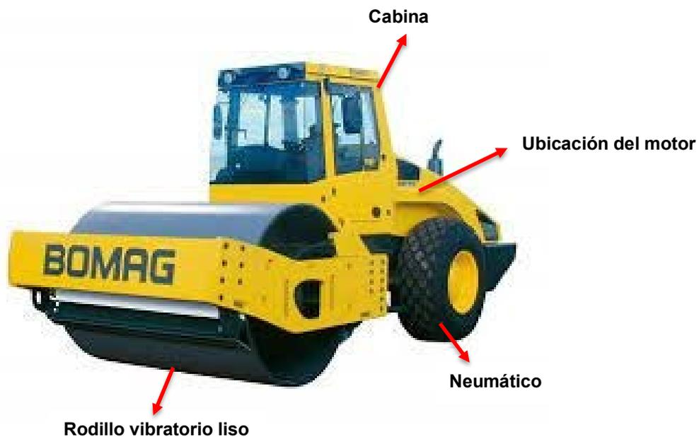
**Figura N° 4:** Partes externas de un rodillo liso
