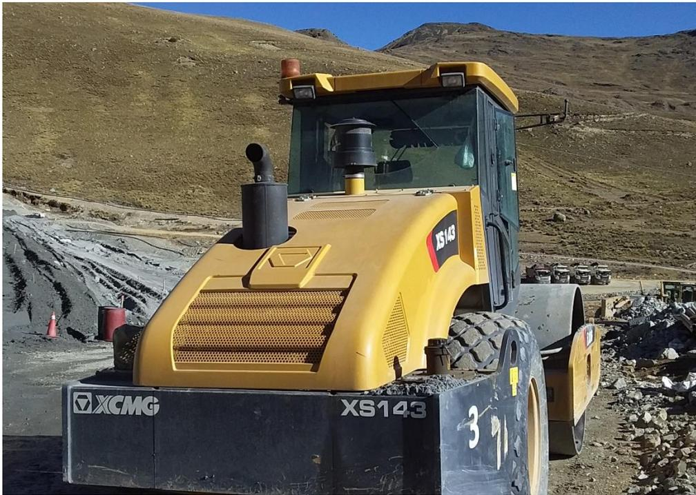
*Figura N° 8: Rodillo liso XCMG XS143*
