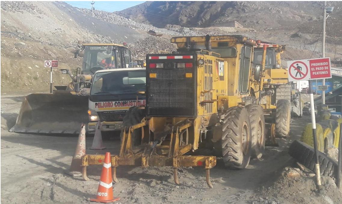
**Figura N° 12:** Motoniveladora Caterpillar 120K
