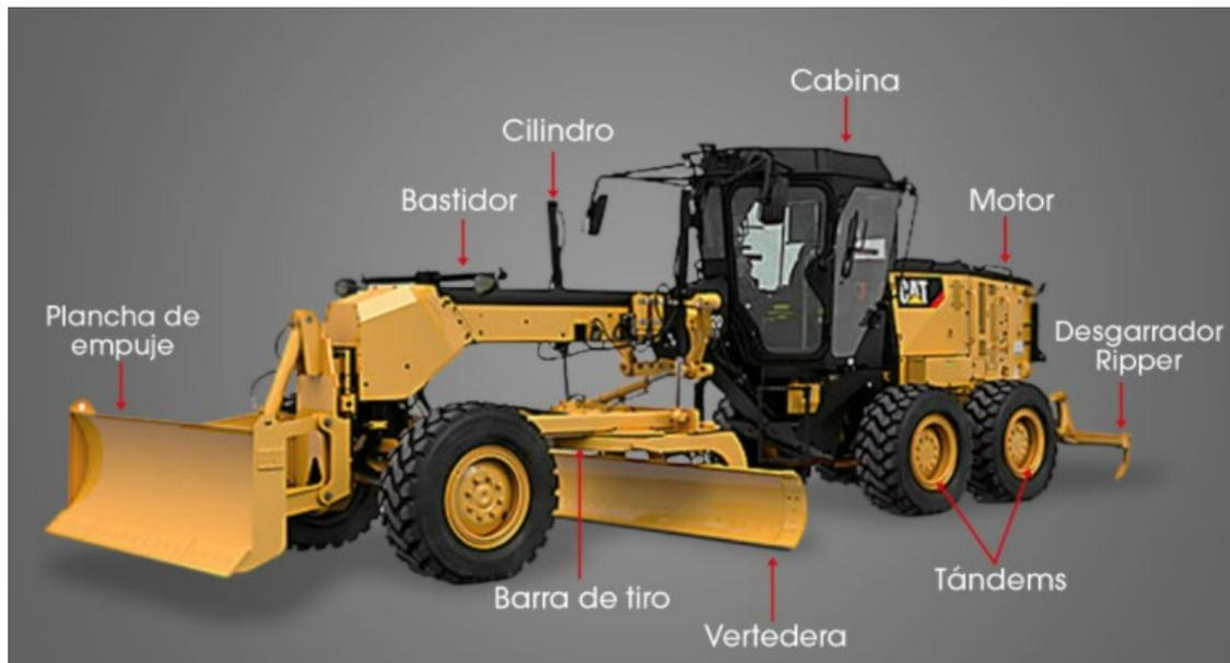
**Figura N° 3:** Partes externas de una motoniveladora
