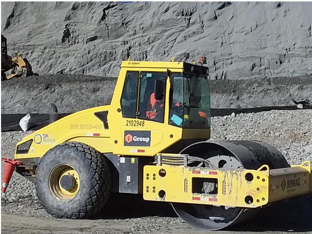
*Figura N° 9: Rodillo liso Bomag BW 211 D-40*
