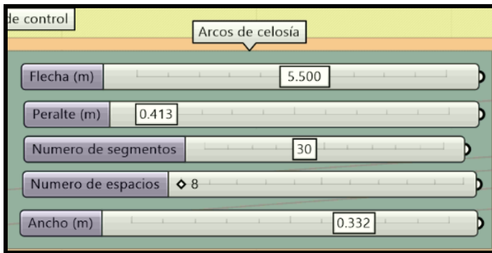
Figura 3.42. Características geométricas modificadas para los arcos de celosías después de la optimización-Campo deportivo N° 01.
