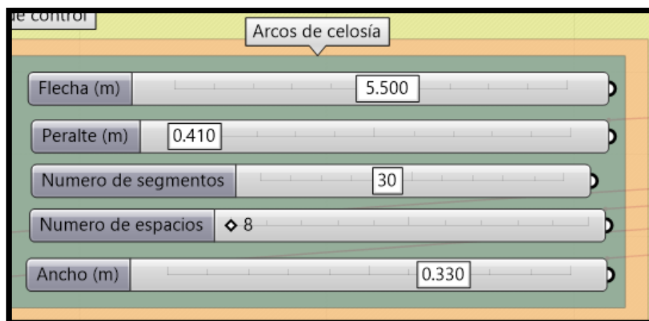
Figura 3.43. Características geométricas de la solución óptima final para los arcos de celosía- Campo deportivo N°01.
