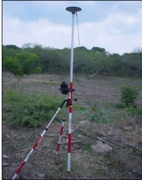
Figura 2. Receptor en punto de poligonal tomando lecturas de posición.
