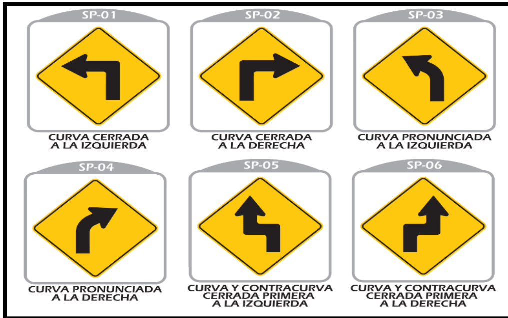
Figura 2.7. Ejemplo de señales preventivas – curvatura horizontal.
