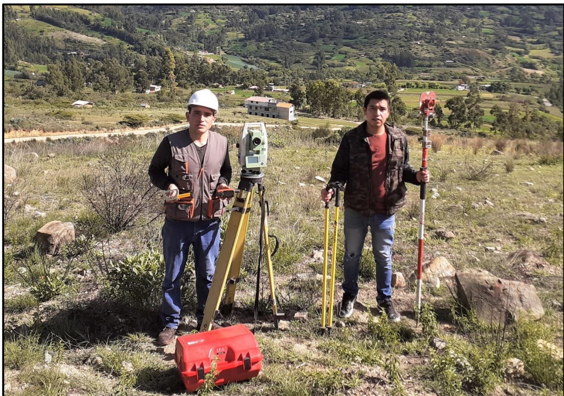
Foto A.6. Equipo de trabajo para el levantamiento topográfico (Estación Total Leica y complementos, Gps y Eclímetro)
