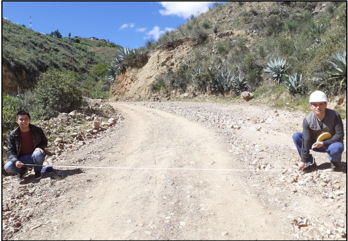
Foto A.13. Medición de ancho de la calzada en la progresiva km 00+960 (con cinta métrica de 50m).
