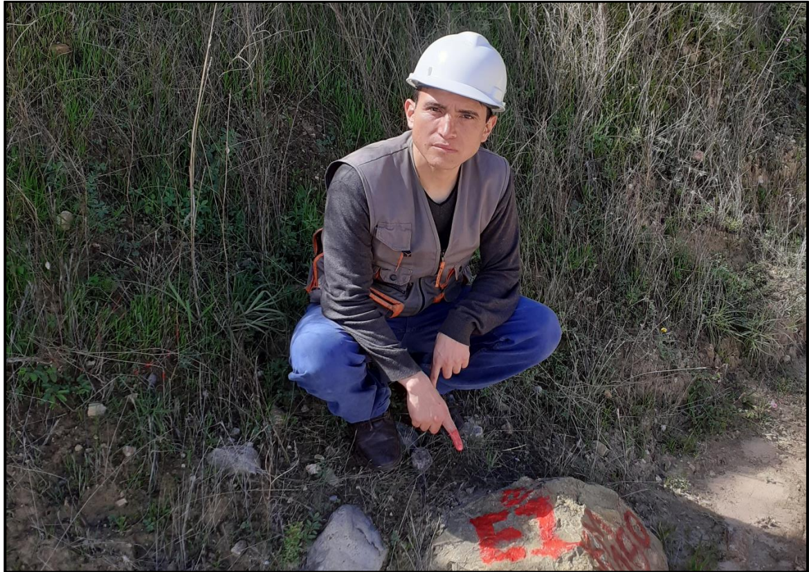
Foto A.11. Materialización de los puntos de estación en campo.
