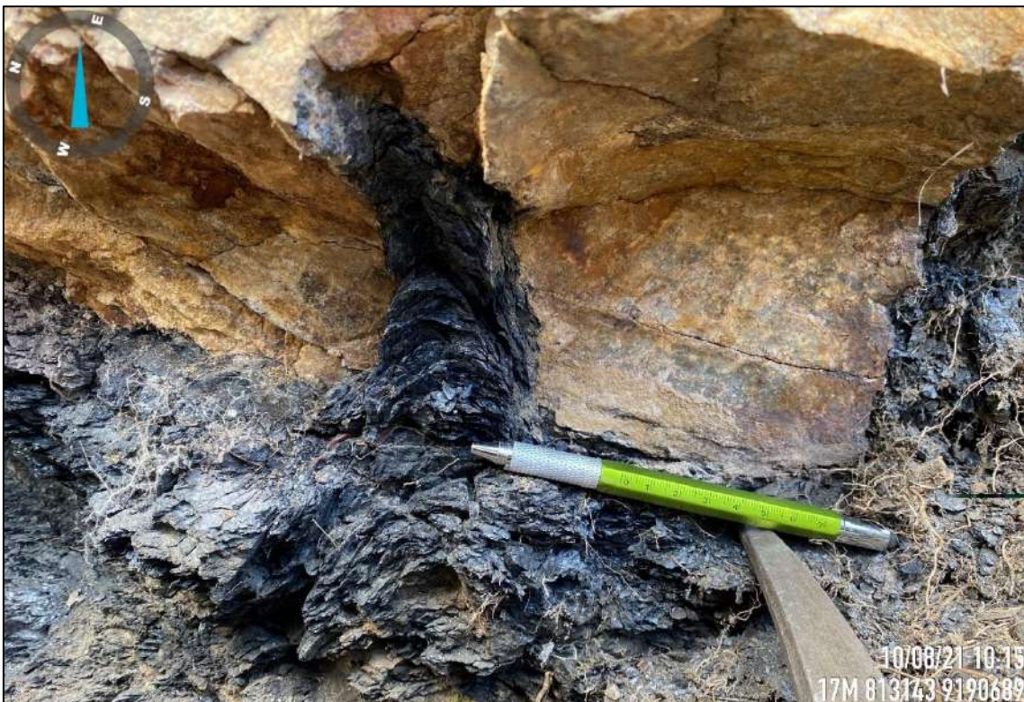
Figura 38. Se observa que el carbón se depositó en areniscas cuarzosas de la Formación Chimú, en un ambiente de sedimentación regresivo, en un sistema deltaico se evidencia secuencias geométricas de formas lenticulares, sus dimensiones laterales son reducidas sus capas lisas y astillosas, con bandas mates y brillosas.
