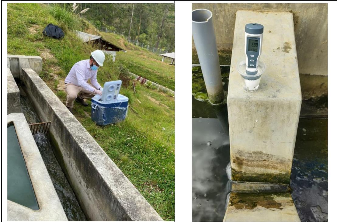
Fotografía N° 5: Toma de muestras del efluente y afluente de la planta de tratamiento de aguas residuales.
