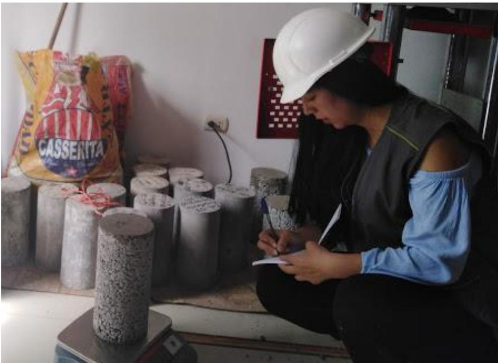
*Fotografía N°22: Peso de probetas en estado endurecido*
