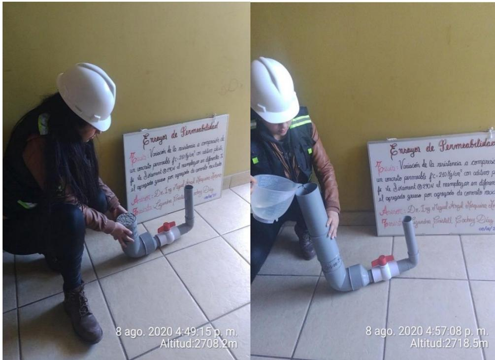
Fotografía N°25: Ejecución de ensayo de permeabilidad
