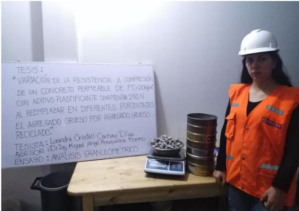
Fotografía N°3: Ensayo de análisis granulométrico
