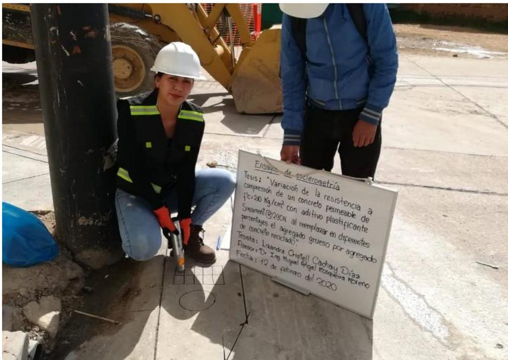
Fotografía N°6: Ejecución de ensayo de esclerometría
