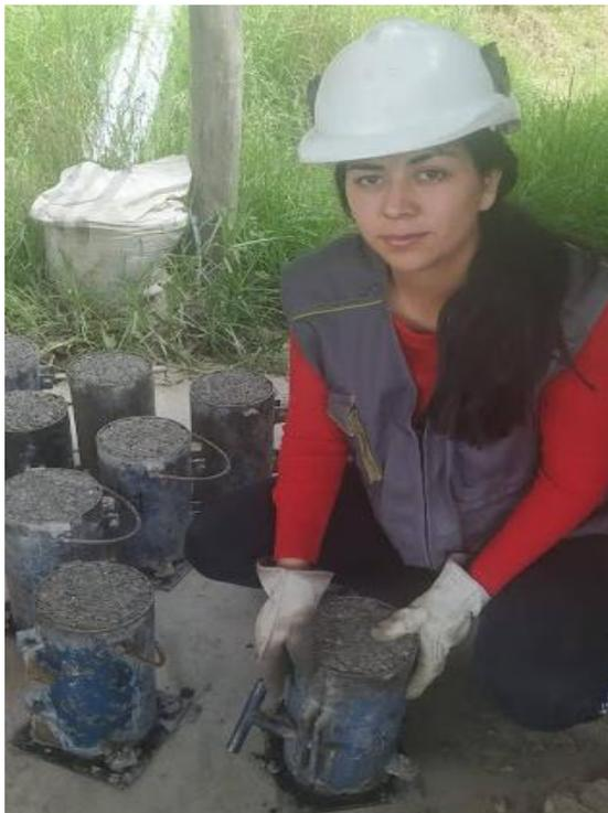
*Fotografía N°16: Desmolde de especímenes cilíndricos*
