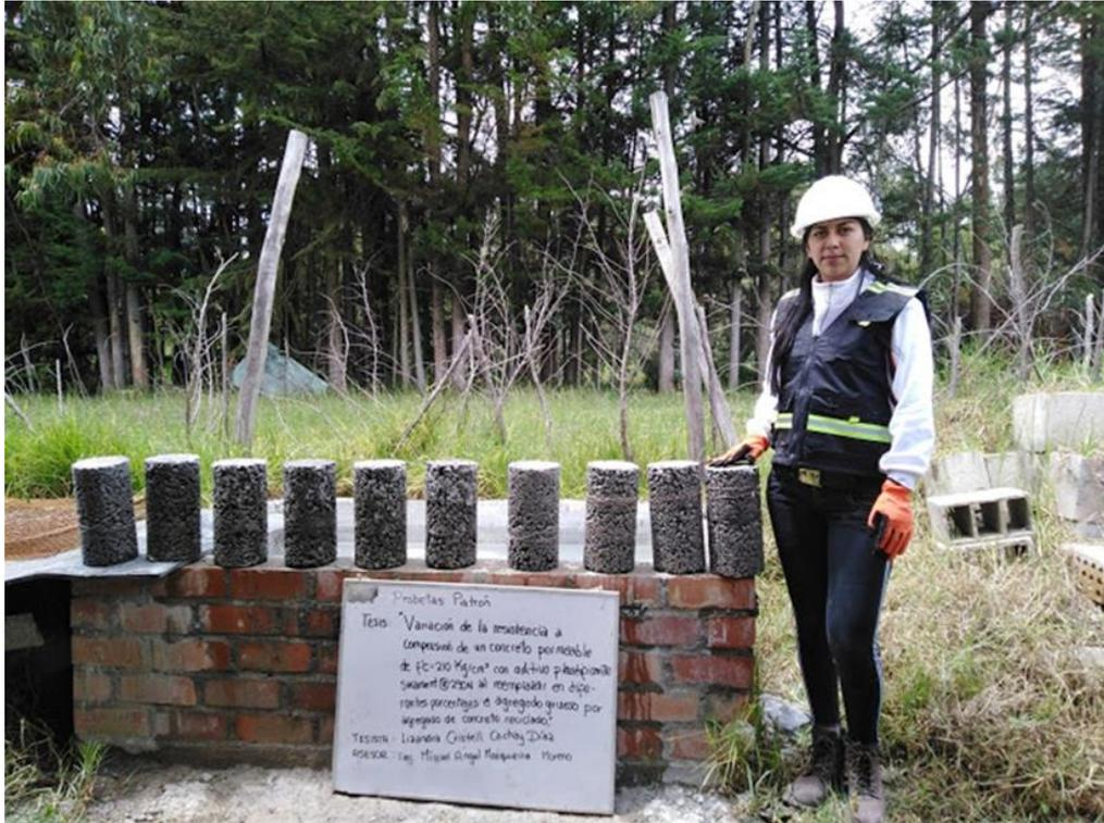
Fotografía N°19: Especímenes posteriormente al proceso de curado
