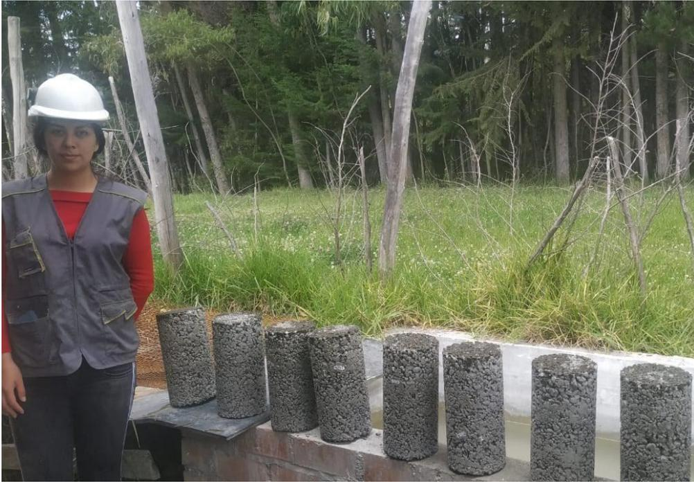
*Fotografía N°17: Especímenes cilíndricos desencofrados*
