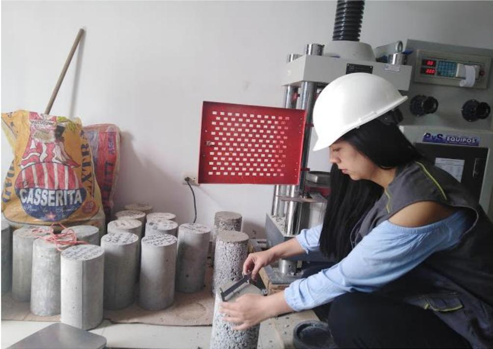
*Fotografía N°21: Medición de diámetros de especímenes en estado endurecido*
