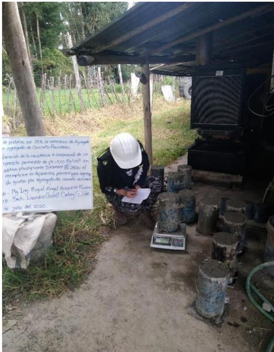
*Fotografía N°15: Peso de especímenes cilíndricos en estado fresco*
