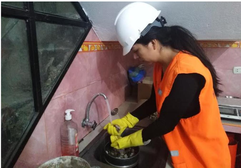
Fotografía N°4: Ensayo para la determinación de porcentaje de material más fino que el tamiz N°200
