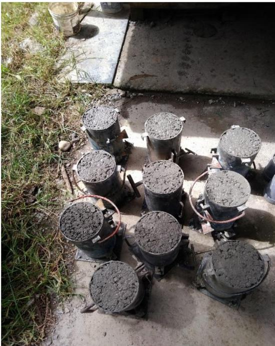
*Fotografía N°14: Especímenes cilíndricos en estado fresco*
