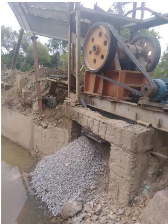
*Fotografía N°8: Tituración de bloques de concreto y obtención de ACR*
