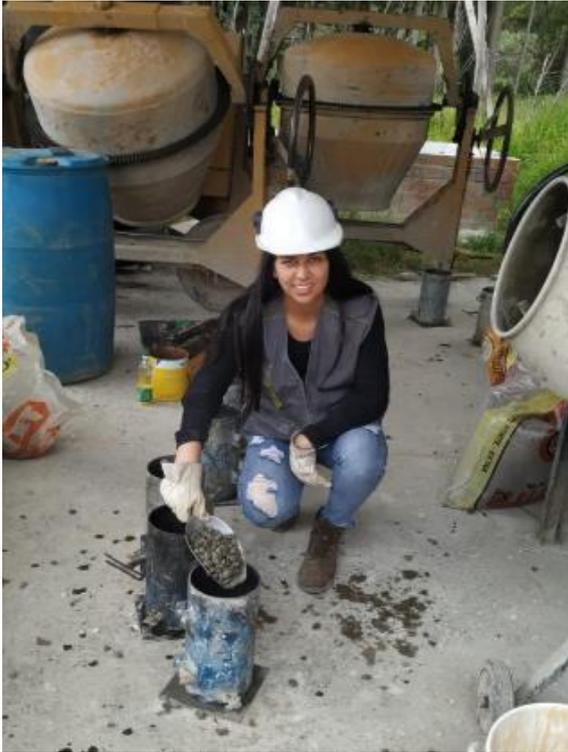
Fotografía N°11: Modelado de concreto permeable
