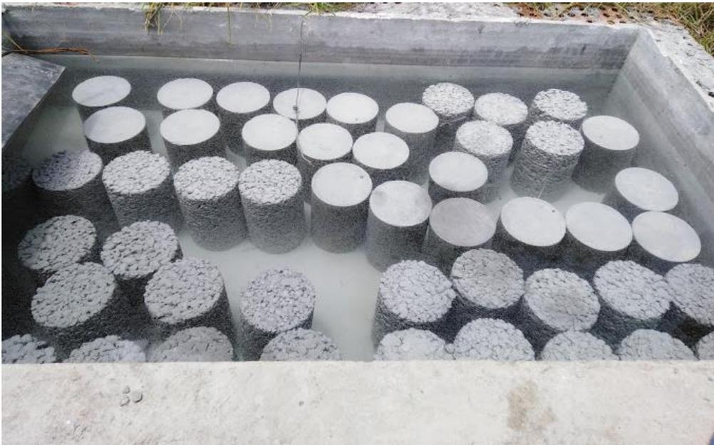
*Fotografía N°18: Curado de especímenes cilíndricos*
