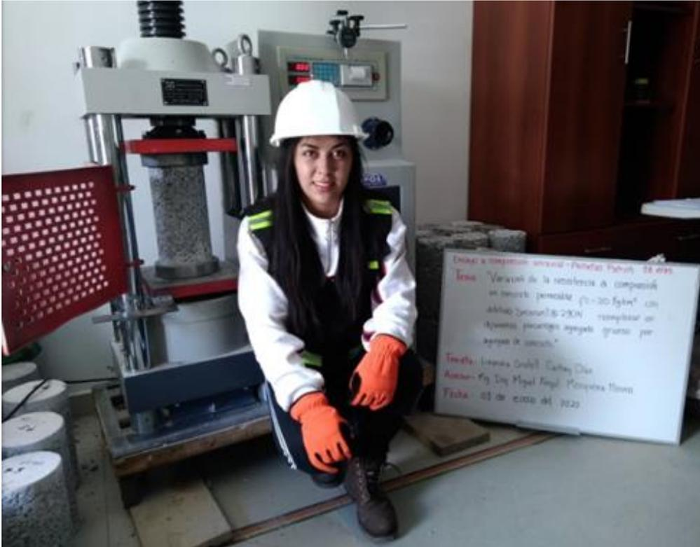
Fotografía N°23: Prensa hidráulica para ensayos a compresión uniaxial
