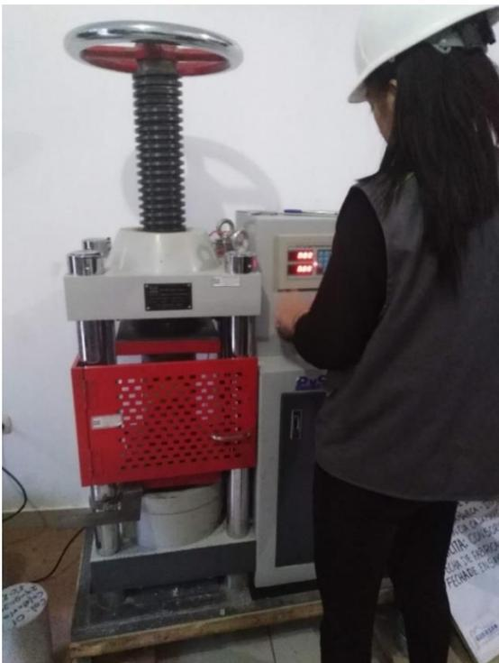
Fotografía N°24: Ejecución de ensayo a compresión uniaxial
