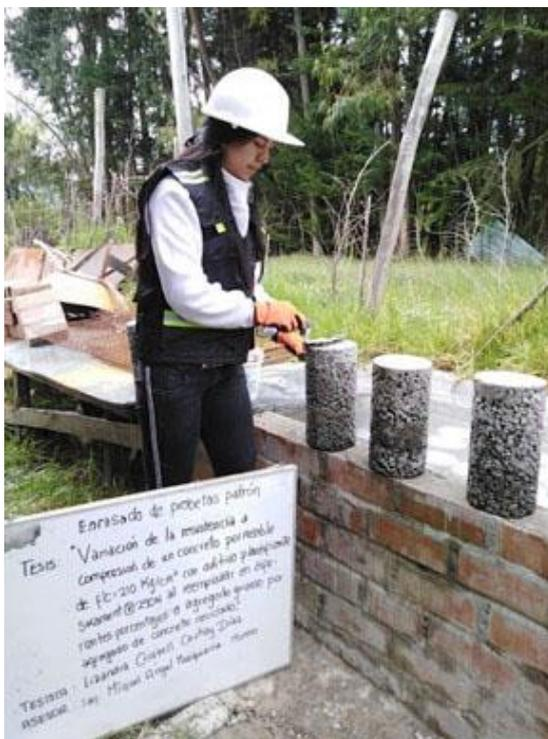
Fotografía N°20: Enrase de superficie de especímenes cilíndricos
