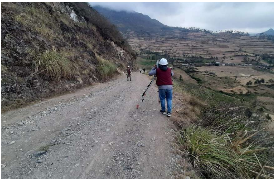
Fotografía N°04: Medición de pendiente con estación total.
