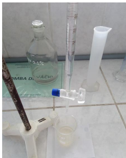
Figura 22. Determinación de acidez mediante método de titulación
