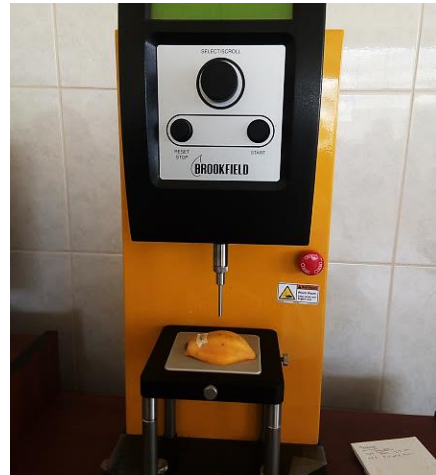
Figura 15. Determinación de dureza mediante uso del texturómetro
