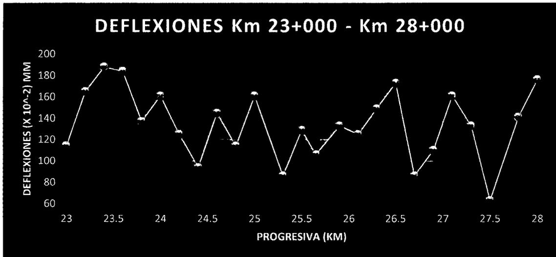
Figura 2.16. Deflectograma para evaluar el estado estructural de la vía.
