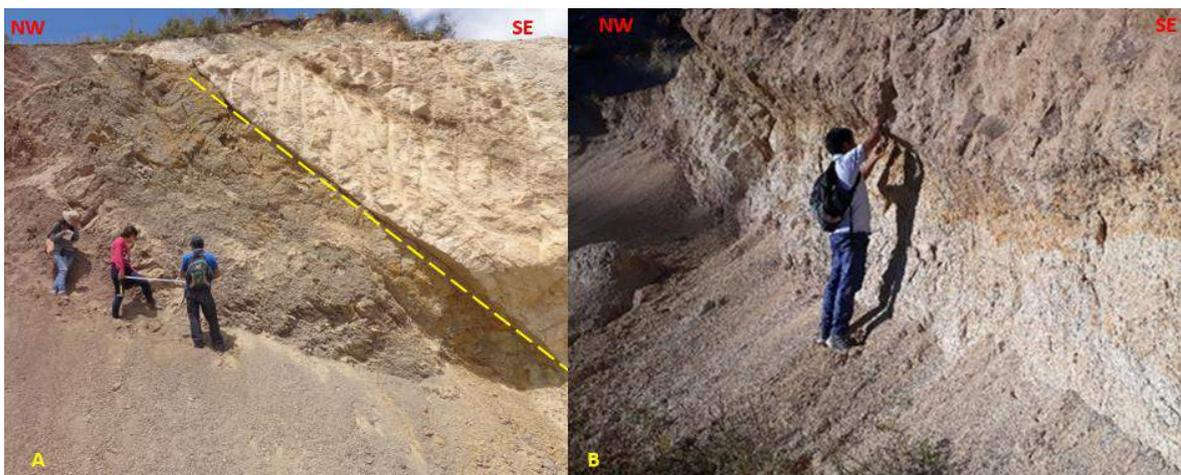
Imagen 3. 14: (A) Estratificación en la parte norte del área de cimentación; (B) Medición del estrato de la parte sur del área de sedimentación.
