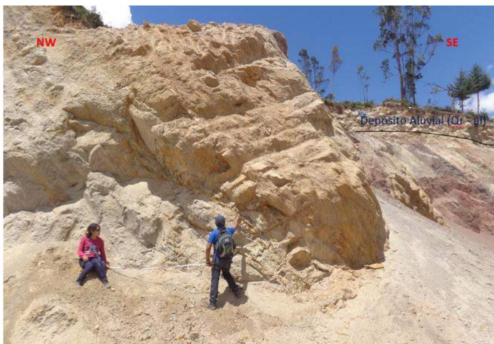
Imagen 3. 17: Estratos de suelos de la formación Chota con mayor resistencia a la meteorización y erosión.
