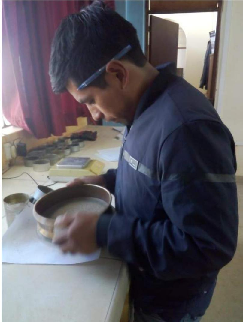
Fotografía 3. 12: Realización del tamizado para el análisis granulométrico.
