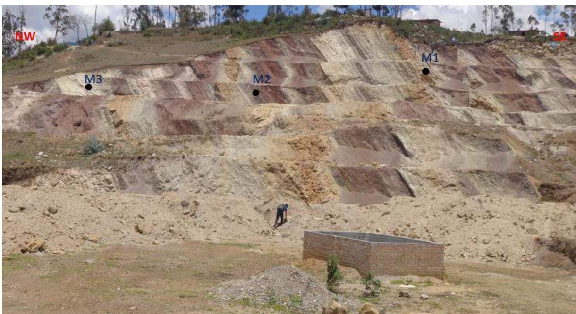
Imagen 3. 18: Muestras tomadas para los ensayos de suelos.
