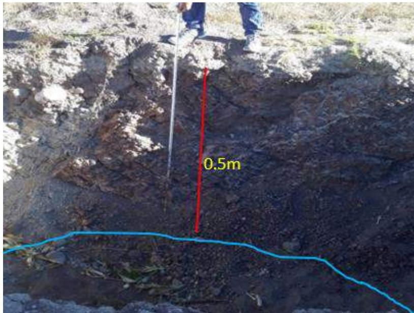
Fotografía 3. 7: Calicata N° 04 en estratos limos arcillosos con coordenadas UTM DATUM WGS-84 E: 773 386; N:9 261 900. Cota: 2 577msnm.
