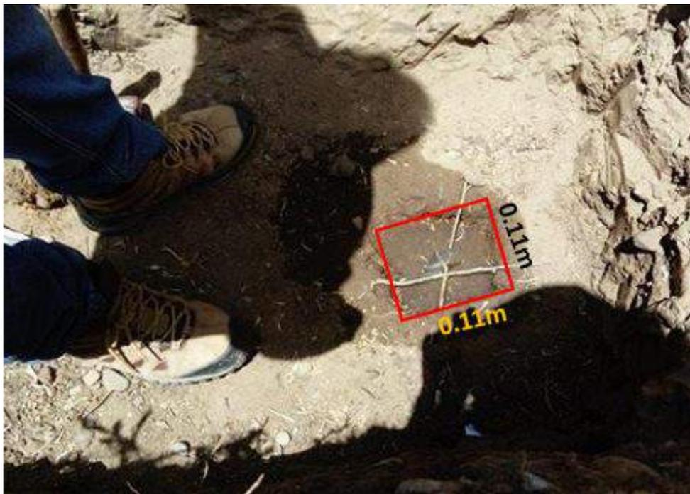
Fotografía 3. 4: Ensayo in situ de permeabilidad en suelo limo arcilloso.
