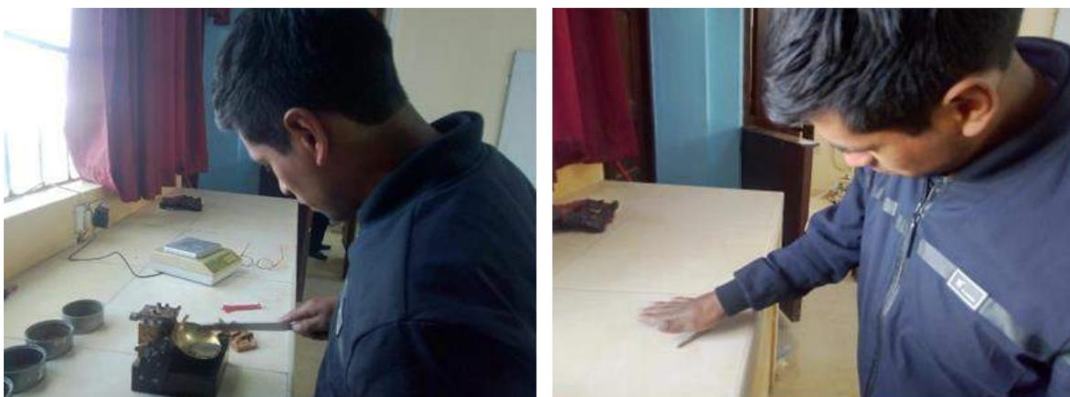
Fotografía 3. 13: Ejecución del Límite Líquido (Izquierda) y límite plástico (Derecha).
