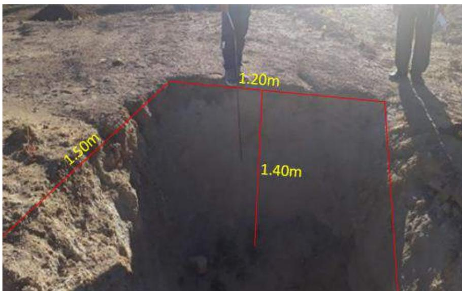
Fotografía 3. 8: Calicata N° 05 en estrato de arena limosa amarillenta con coordenadas UTM DATUM WGS-84 E: 773 419 y N:9 261 912. Cota: 2 582msnm.
