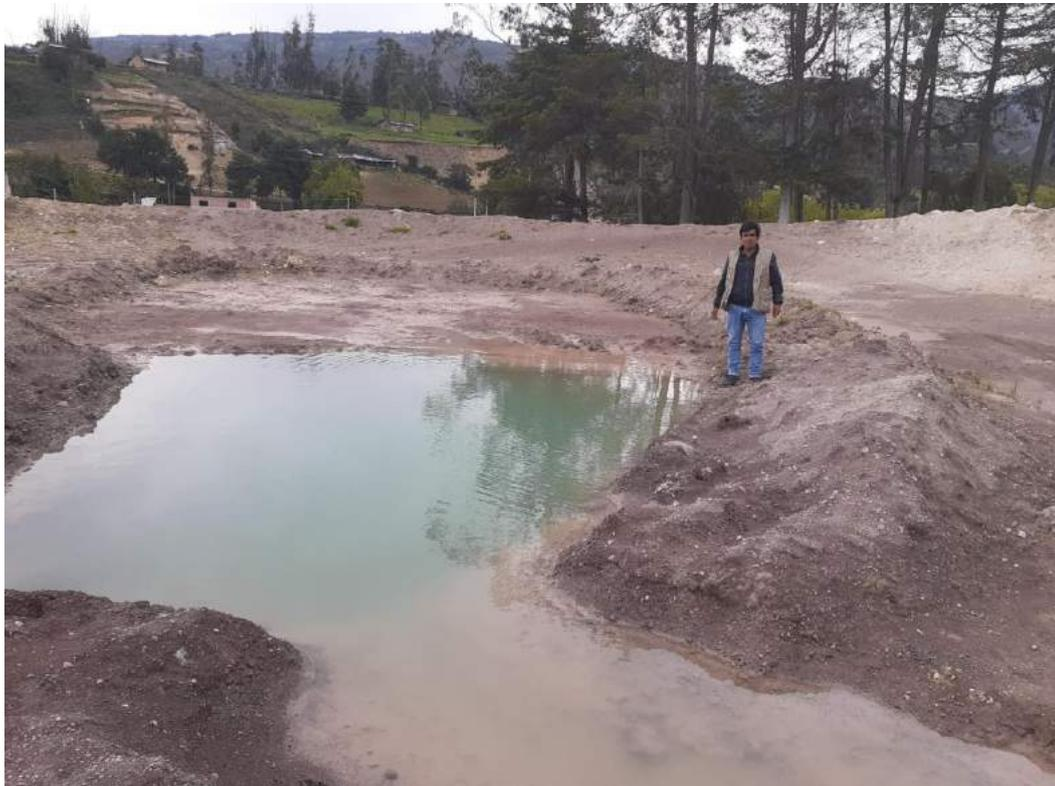
Fotografía 6. 6: Afloramiento de agua subterránea en calicata N° 02.
