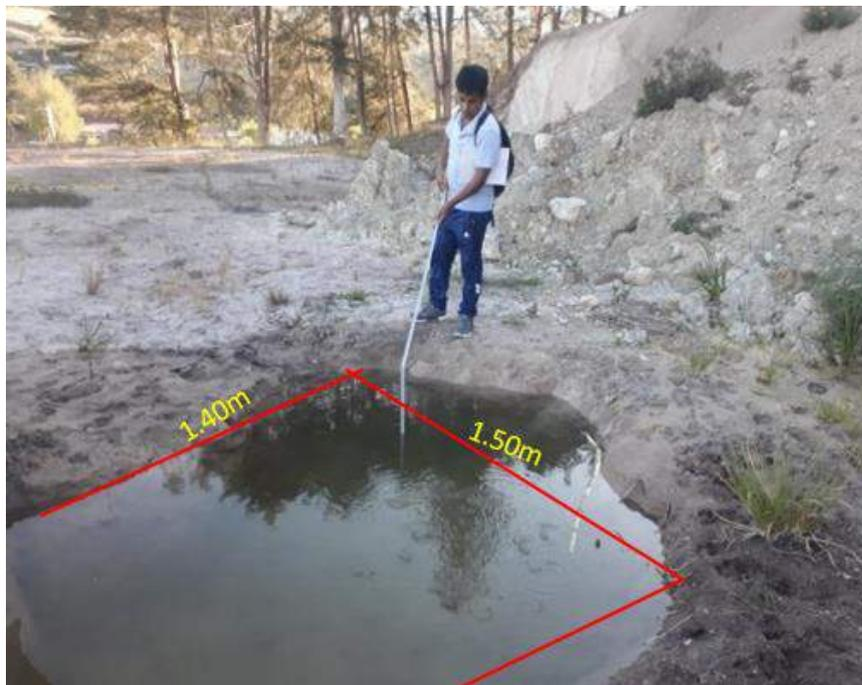
Fotografía 3. 6: Calicata N° 02 en suelos limos arcillosos blanquecinos con coordenadas UTM DATUM WGS-84 E: 773 357; N:9 261 968. Cota: 2 577msnm.
