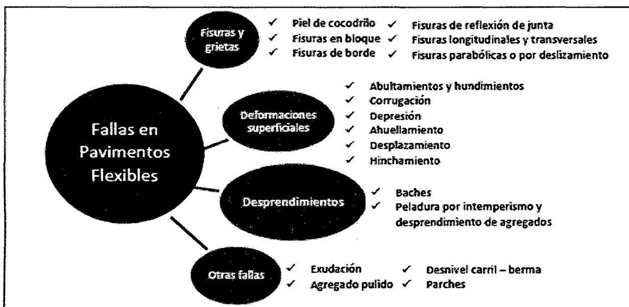
Figura 2.3. Fallas en pavimentos flexibles. (Fuente: Vásquez, 2002)
