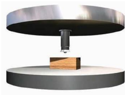
Figura 15. Esquema de ensayo de dureza. Puede medirse en forma normal o paralela a la fibra. (Fritz Durán, 2004).
