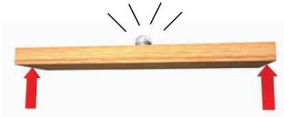
Figura 11. Esquema de ensayo de tenacidad. (Fritz Durán, 2004).
