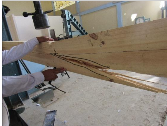
1. Proceso del ensayo a flexión de las vigas macizas, toma de datos y análisis de las fallas que se presentaron.
