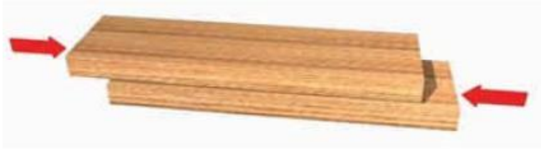
Figura 12. Esquema de ensayo de cizalle longitudinal. (Fritz Durán, 2004).
