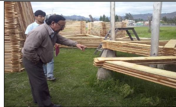
4. Secado al aire de láminas de madera de 1 ¼" espesor para fabricación de elementos laminados.
