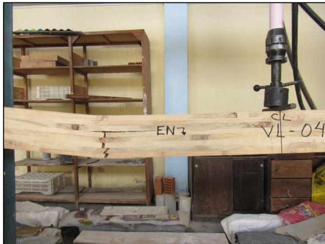
1. Proceso del ensayo a flexión de las vigas laminadas, toma de datos y análisis de las fallas que se presentaron.
