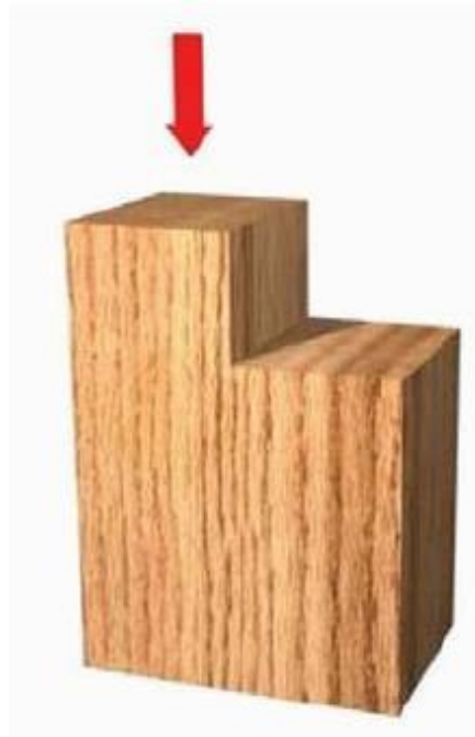
Figura 13. Esquema de ensayo de cizalle paralelo tangencial. (Fritz Durán, 2004).
