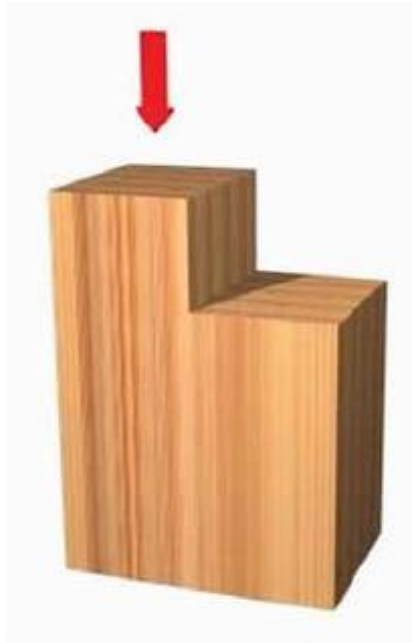
Figura 14. Esquema de ensayo de cizalle paralelo radial. (Fritz Durán, 2004).
