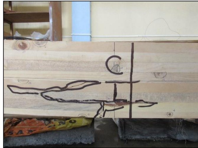
1. Proceso del ensayo a flexión de las vigas laminadas, toma de datos y análisis de las fallas que se presentaron.
