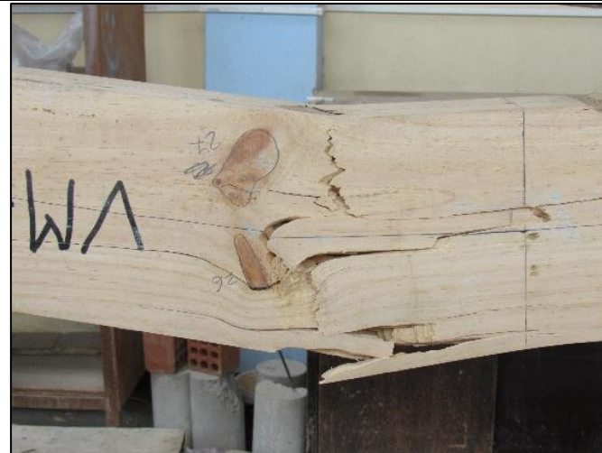
1. Proceso del ensayo a flexión de las vigas macizas, toma de datos y análisis de las fallas que se presentaron.
