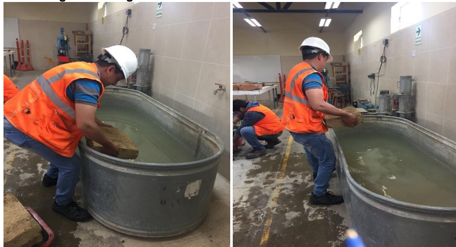
Figura 154: Ingreso Adobe Patrón 24 horas Absorción
