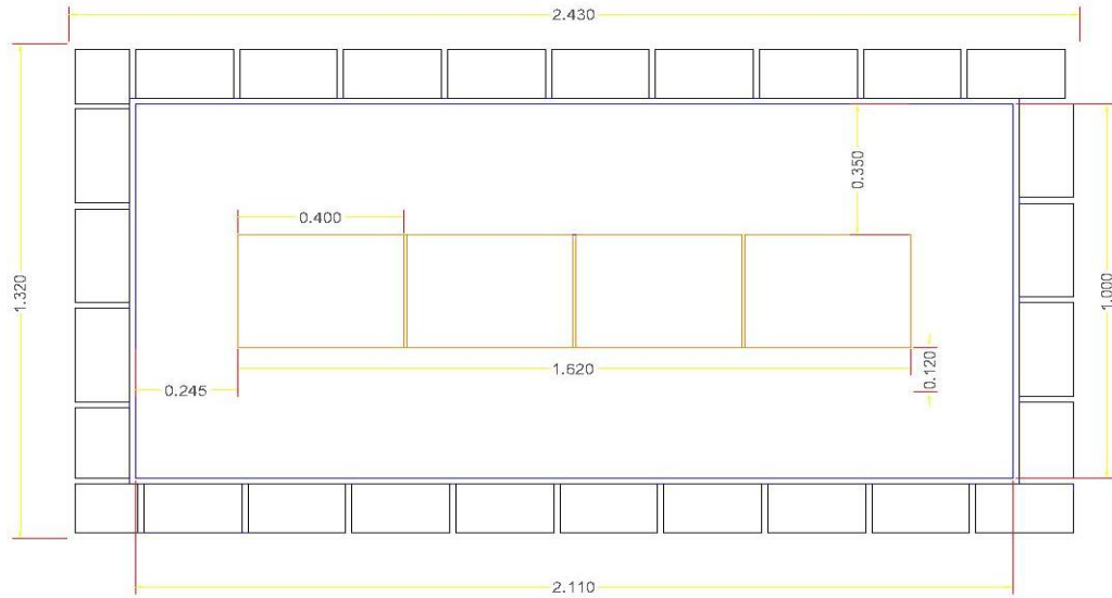
Figura 3: Dimensiones del pozo
