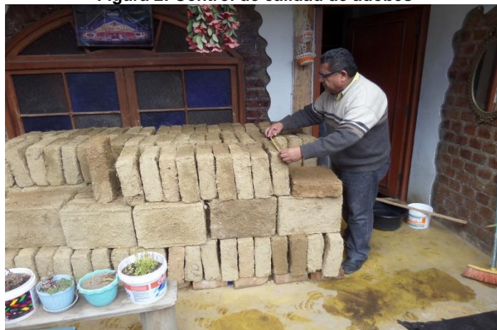
Figura 2: Control de calidad de adobes
