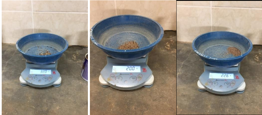
Figura 146: Toma de Datos - Tamizado por Lavado - Suelo Marrón - Malla N° 10 – 20 - 30
