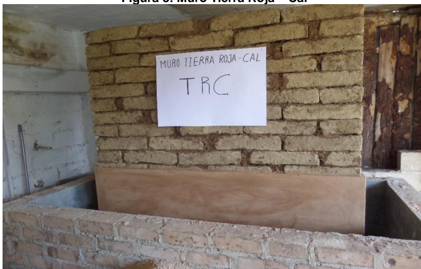
Figura 8: Muro Tierra Roja - Cal
