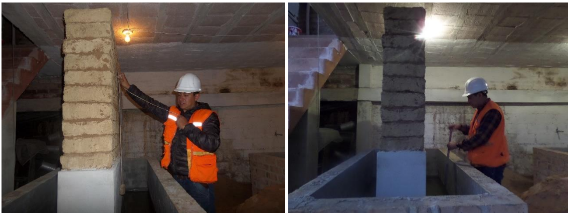
Figura 76: Medidas final segundo periodo - Muro Cemento – Yeso
