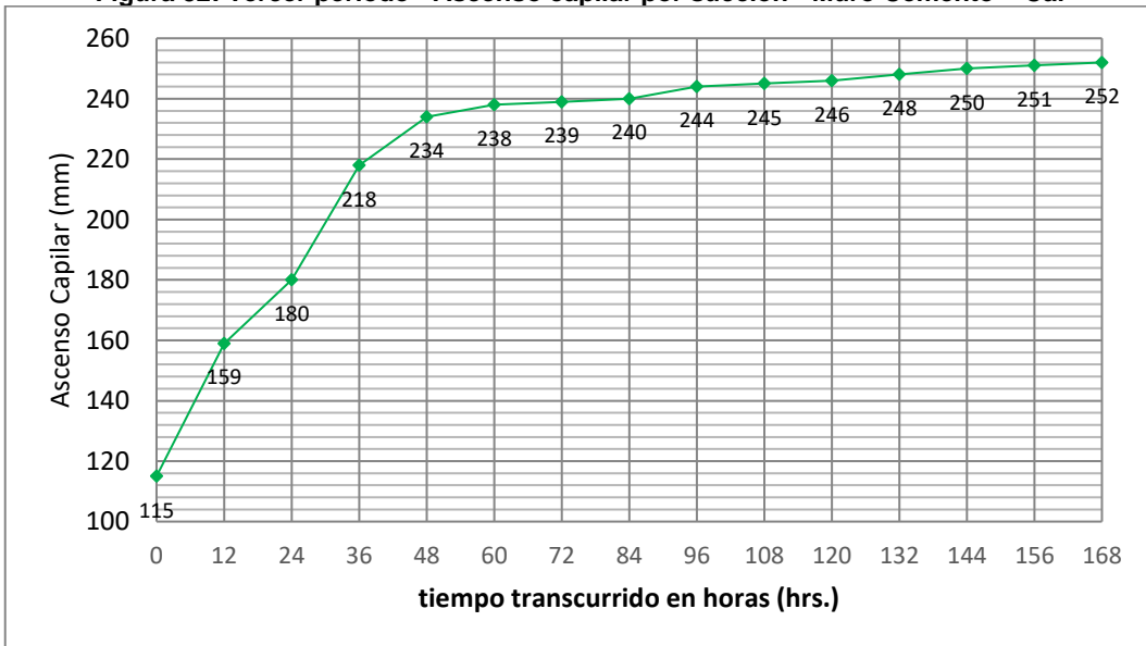
Figura 52: Tercer periodo - Ascenso capilar por succión - Muro Cemento – Cal
