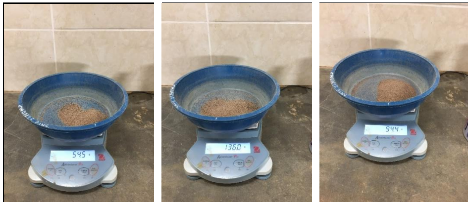
Figura 147: Toma de Datos - Tamizado por Lavado - Suelo Marrón – Malla N° 40 – 60 - 100
