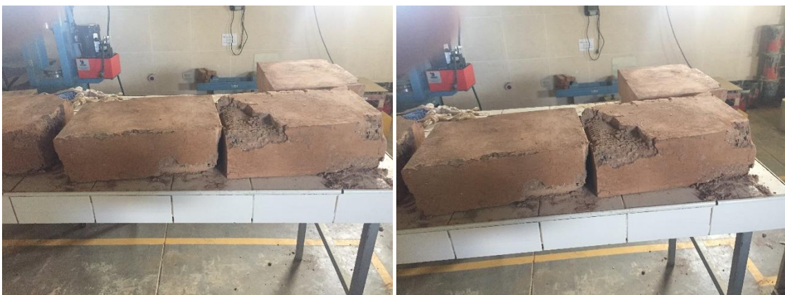
Figura 92: Pérdida de estructura - muestras Adobe Tierra Roja - Cal
