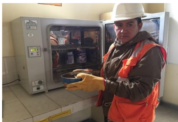
Figura 17: Ingreso de muestras Contenido de Humedad
