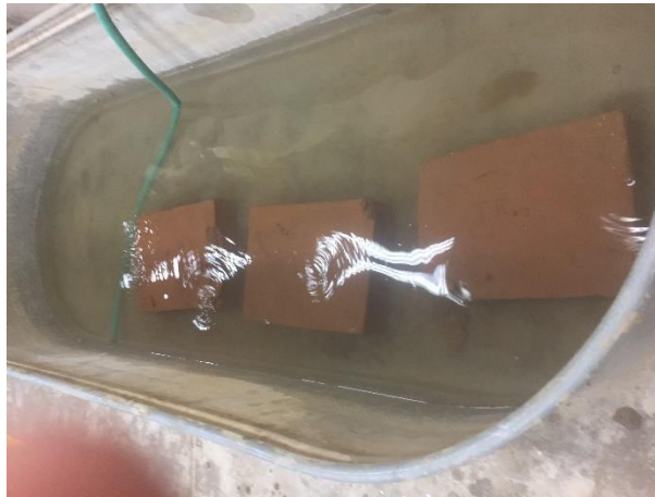
Figura 157: Ingreso Adobe Tierra Roja - Cal 24 horas Absorción
