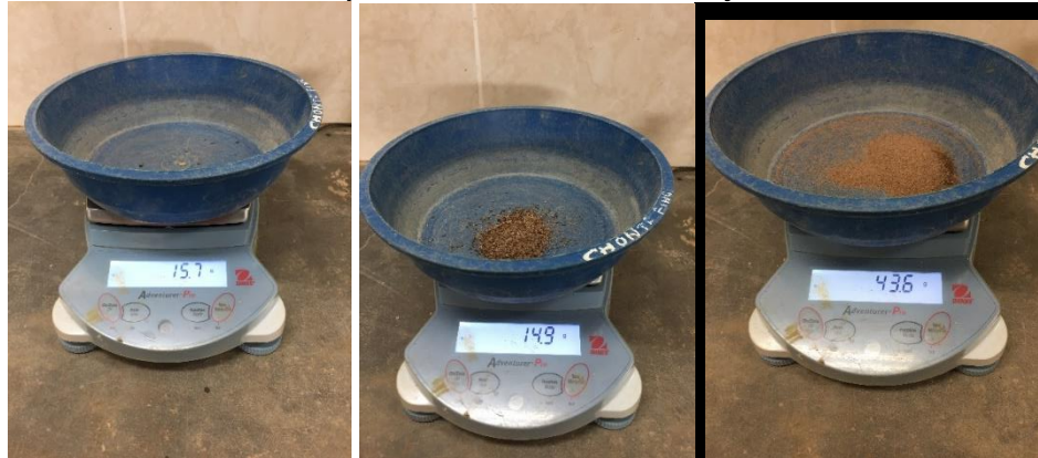
Figura 143: Toma de Datos - Tamizado por Lavado - Suelo Marrón Rojizo - Malla N° 10 – 20 -30
