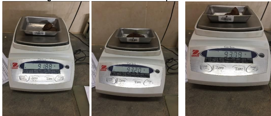
Figura 152: Toma de Datos - Limite Liquido – Suelo Marrón
