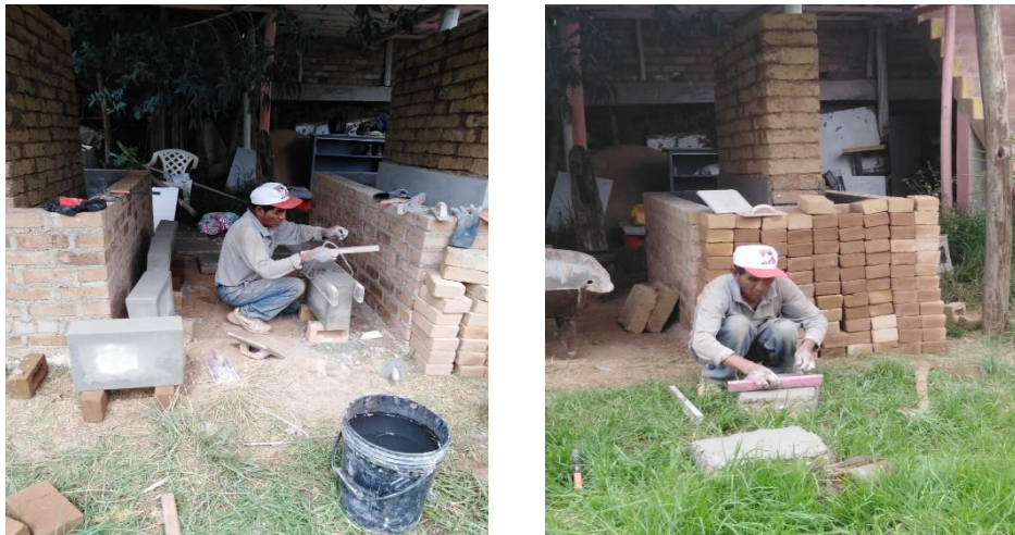
Figura 16: Elaboración muestras individuales Cemento - Yeso
