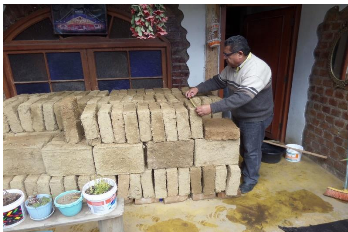
Figura 121: Control de calidad de adobes
