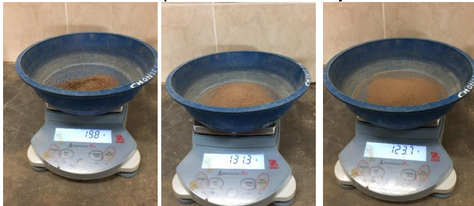
Figura 144: Toma de Datos - Tamizado por Lavado - Suelo Marrón Rojizo – Malla N° 40 – 60 - 100
