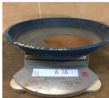
Figura 145: Toma de Datos - Tamizado por Lavado - Suelo Marrón Rojizo – Malla N° 200
