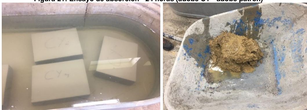
Figura 21: Ensayo de absorción - 24 horas (adobe CY - adobe patrón)
