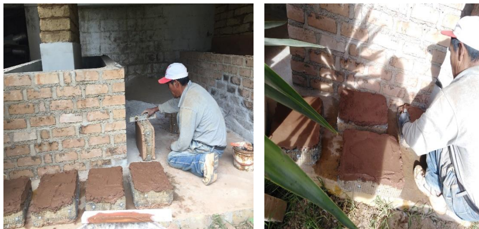
Figura 15: Elaboración muestras individuales Tierra Roja - Cal
