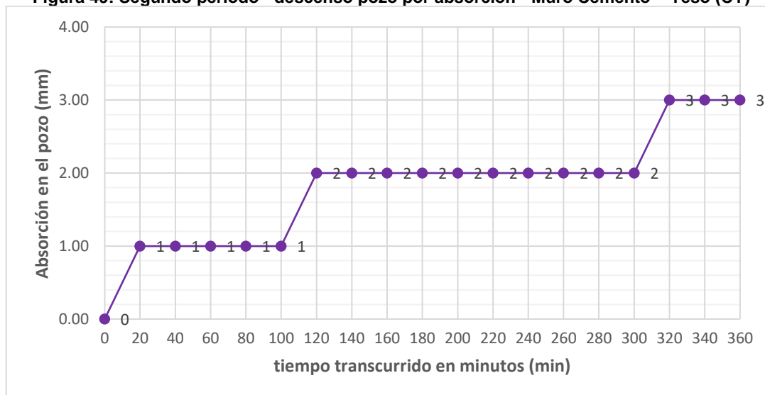
Figura 49: Segundo periodo - descenso pozo por absorción - Muro Cemento – Yeso (CY)
