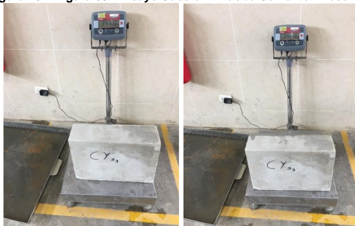
Figura 167: Figura 59: Ensayo Succión - Adobe Cemento - Yeso N° 3
