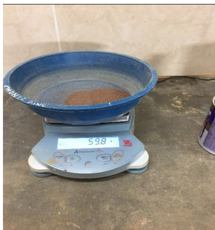
Figura 148: Toma de Datos - Tamizado por Lavado - Suelo Marrón – Malla N° 200
