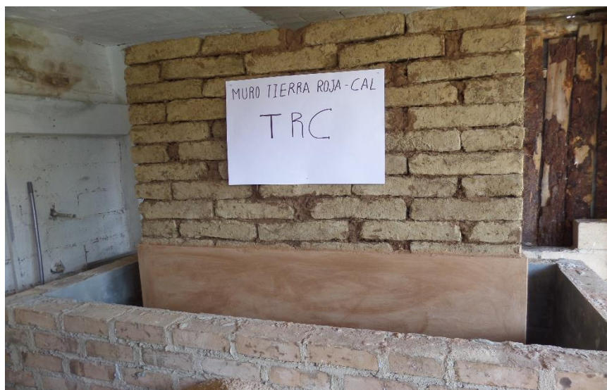
Figura 136: Muro Tierra Roja - Cal
