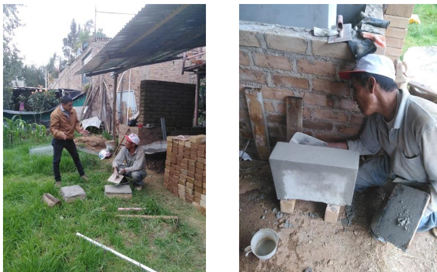
Figura 14: Elaboración muestras individuales Cemento - Cal
