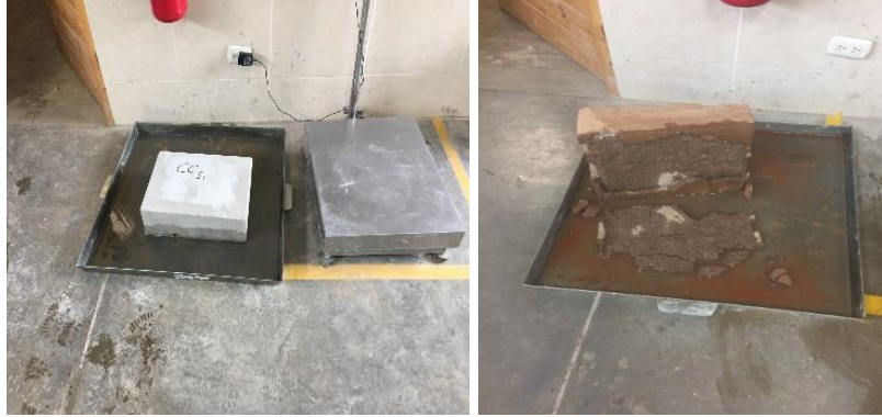
Figura 22: Ensayo succión (Adobe CC - adobe TRC)
