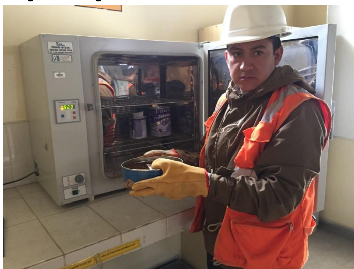
Figura 142: Ingreso de muestras Contenido de Humedad
