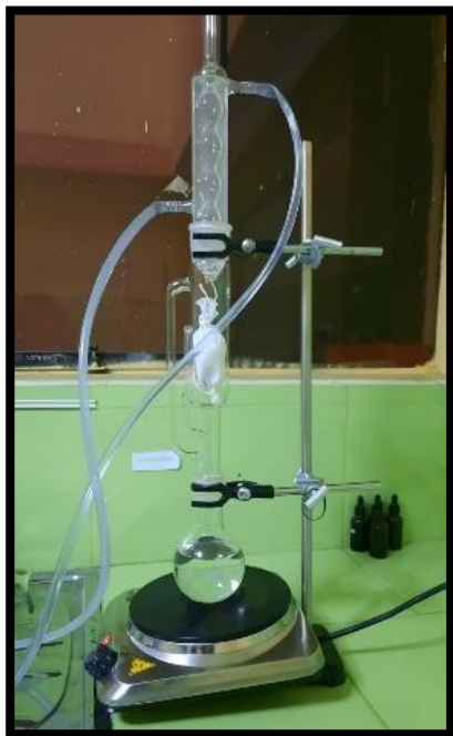
Extracción de saponinas con el equipo Soxhlet.
