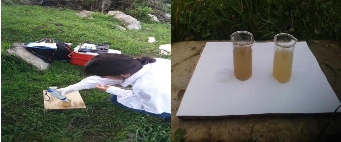
Figura 13. Medición de temperatura y pH en el punto de monitoreo BA1 (afluente y efluente)
