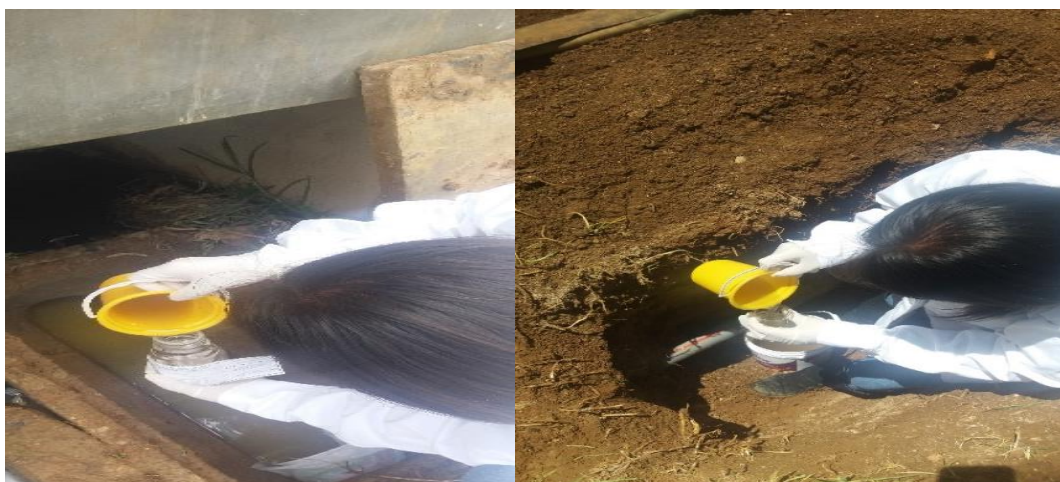
Figura 18. Toma de muestra para CTT de punto de monitoreo BA2 (afluente y efluente)
