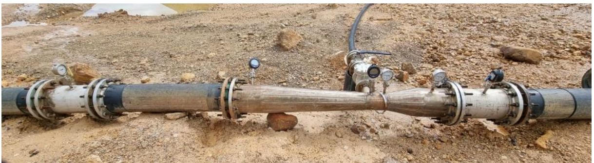
Figura 82: Puntos de medición de presiones en línea aguas arriba y aguas debajo de Venturi
