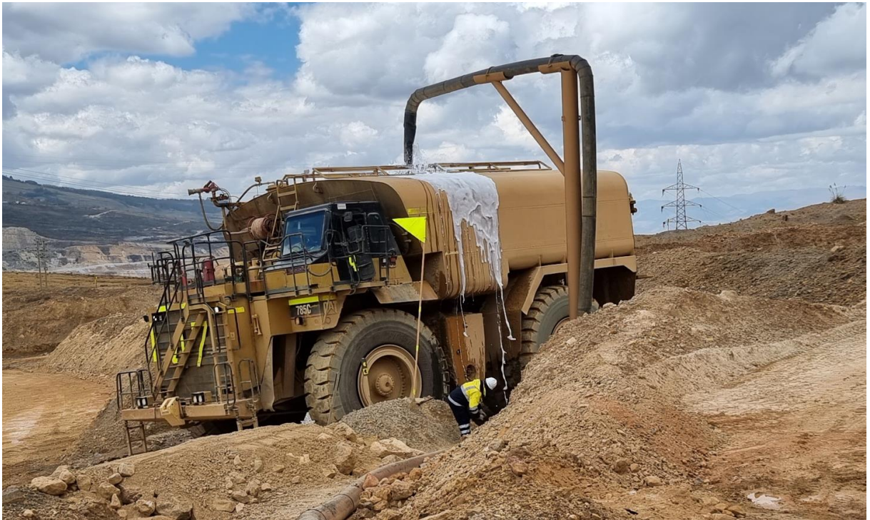
Figura 89: Abastecimiento de camión cisterna con supresor de polvo
