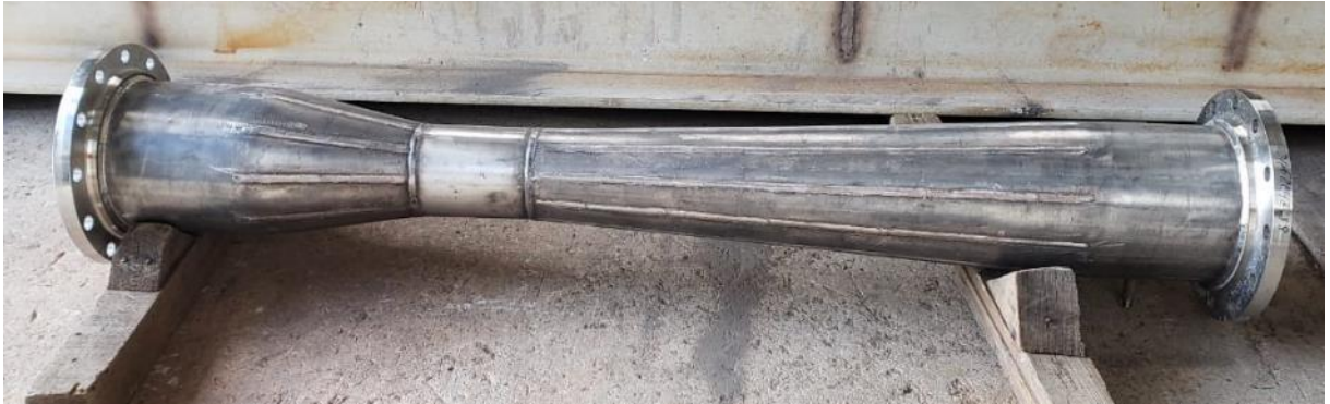
Figura 77: Venturi de chapa en acero inoxidable de 10 pulgadas con garganta de 6 pulgadas
