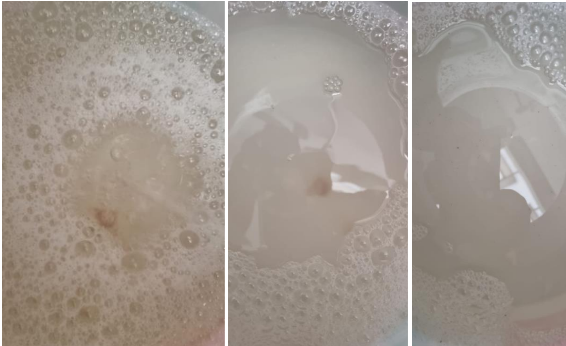
Figura 92: Fotografía de mezcla en recipiente solo por ingreso de agua sin ningún tipo de agitador
