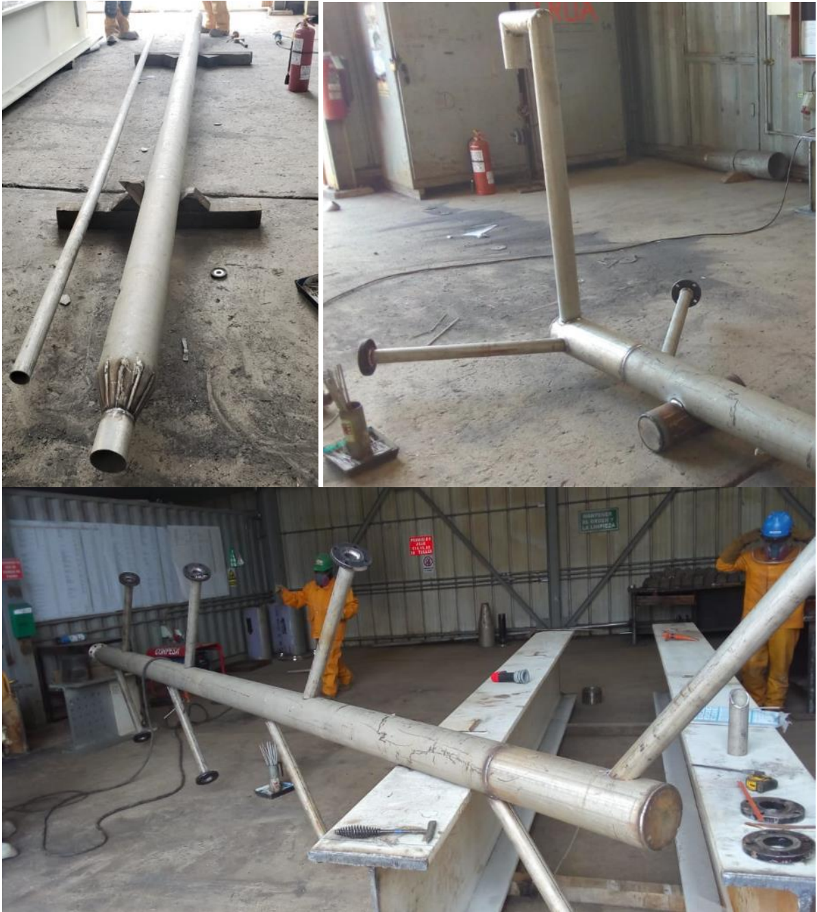
Figura 85: Proceso de fabricación de manifold
