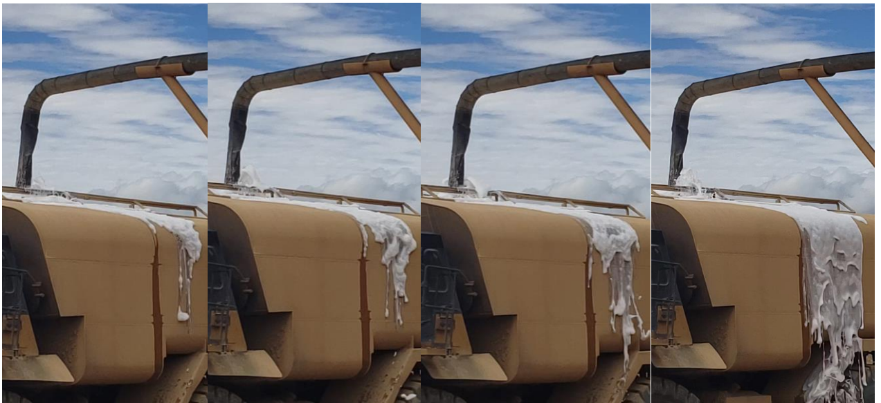
Figura 104: Llenado con supresor de polvo aplicado en inyector de Venturi.
