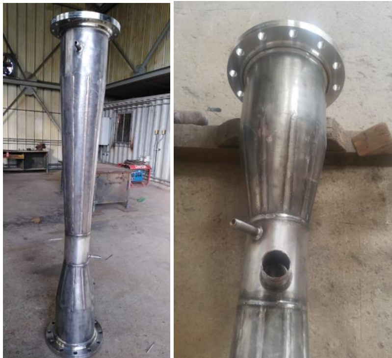
Figura 78: Venturi de chapa de 10 pulgadas con niples para medición de presión
