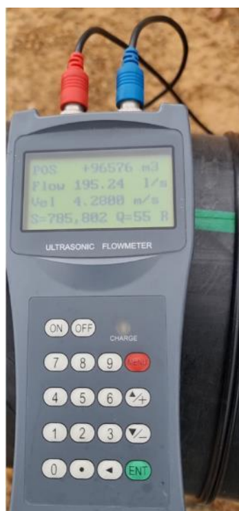
Figura 60: Fotografía de medición de caudal y presión en el punto de control n° 12.
