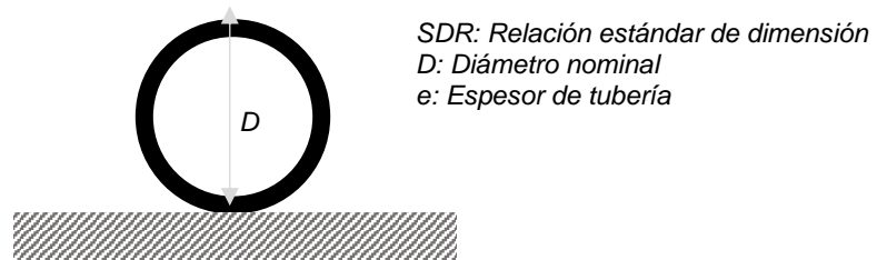
Figura 22: Diagrama conceptual de medidas para verificación de SDR
