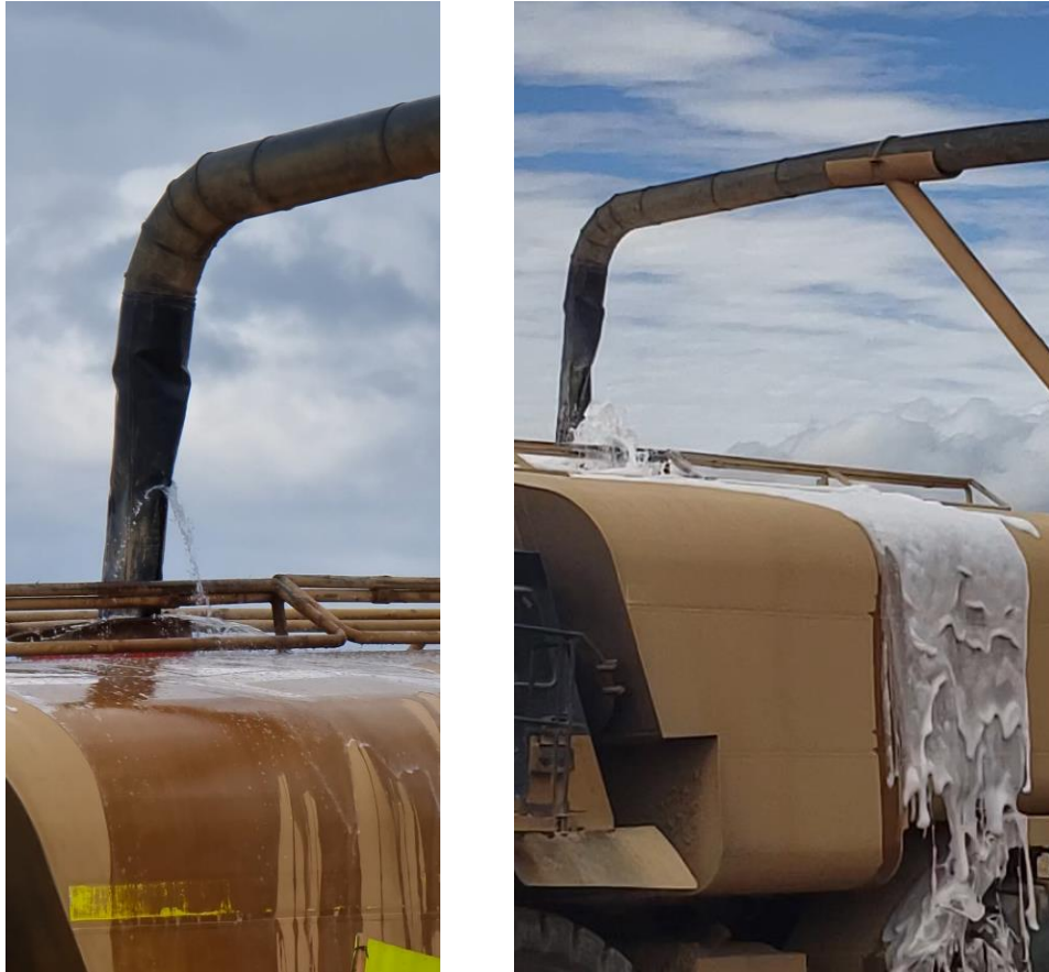
Figura 105:. Comparación de mezcla en poza versus inyector Venturi
