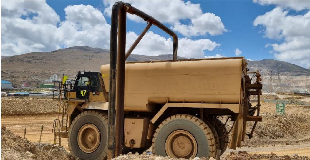
Figura 51: Cisterna de riego de vías en el punto de abastecimiento de agua.
