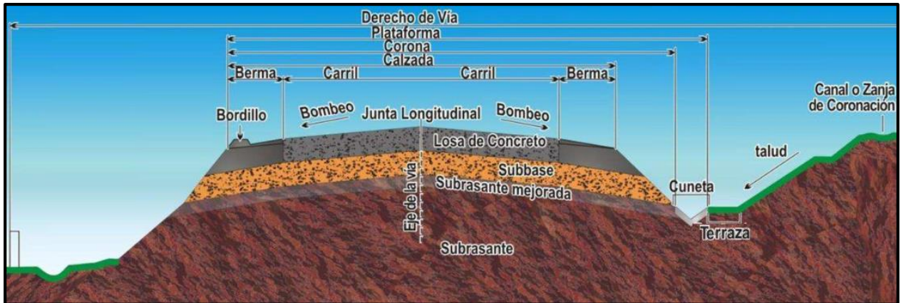
Figura 2. Sección típica de un pavimento rígido
