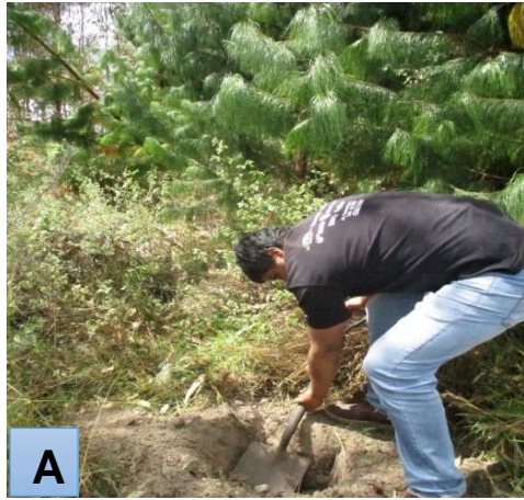
Figura 10. A: Excavación de la calicata, B: Recolección de la muestra de suelos.
