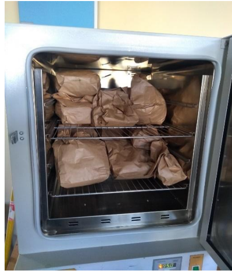
Figura 14. Pesado y secado de las muestras haciendo uso de una balanza electrónica y una estufa.
