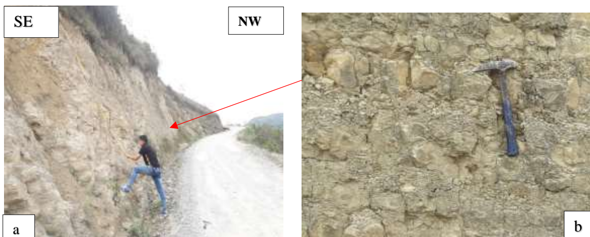
Foto 3.5. a. Litología de la Formación Chúlec, en el flanco izquierdo de la carretera. B. Secuencia sedimentaria rítmica de intercalación de arcillolitas y calizas nodulares, altamente intemperizadas de color amarillento, de espesor de 0.08 a 0.10 m. Coordenadas E: 779123, N: 9265272 cota: 2507 m.s.n.m.
