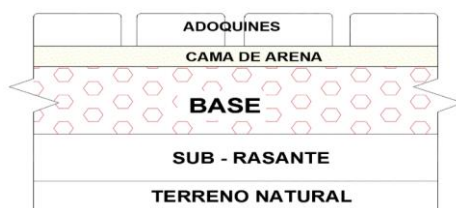
Figura 3. Estructura del pavimento articulado
