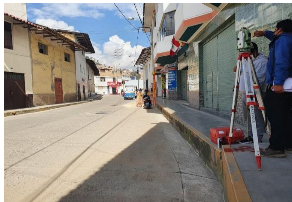
Figura 57. Levantamiento topográfico, desde la estación 01.
