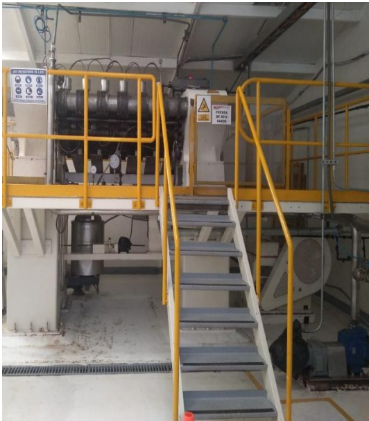
Figura 40. Prensa Horizontal o continua (prensa de 6 vasos)
