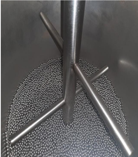
Figura 36. Parte interna del molino de billas o molino de bolas
