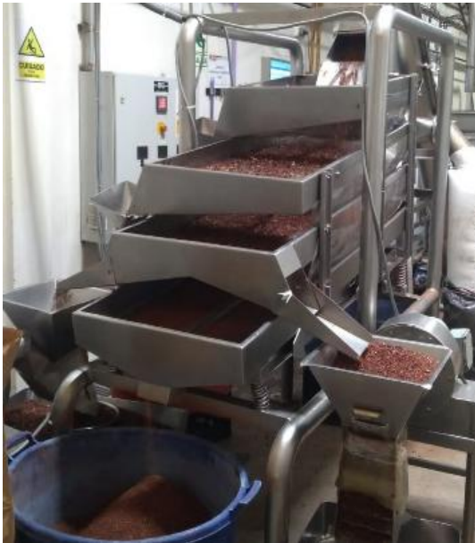
Figura 32. Tamices o zarandas de diferentes tamaños usados para el nibs
