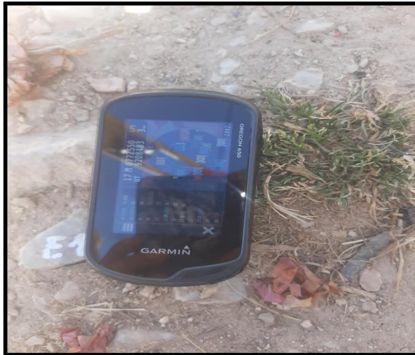
Fotografía N°01: Toma de datos de la estación E1 con GPS Garmin
