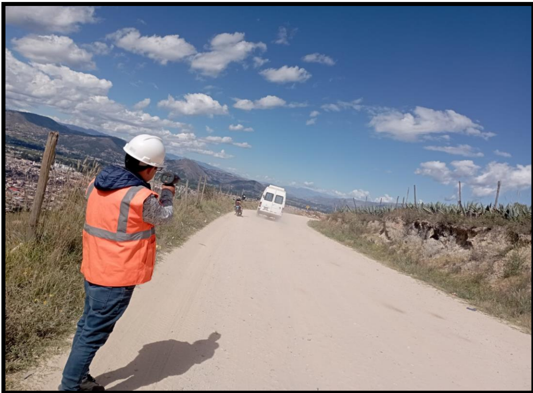
Fotografía N°11: Toma de datos para la velocidad de operación
