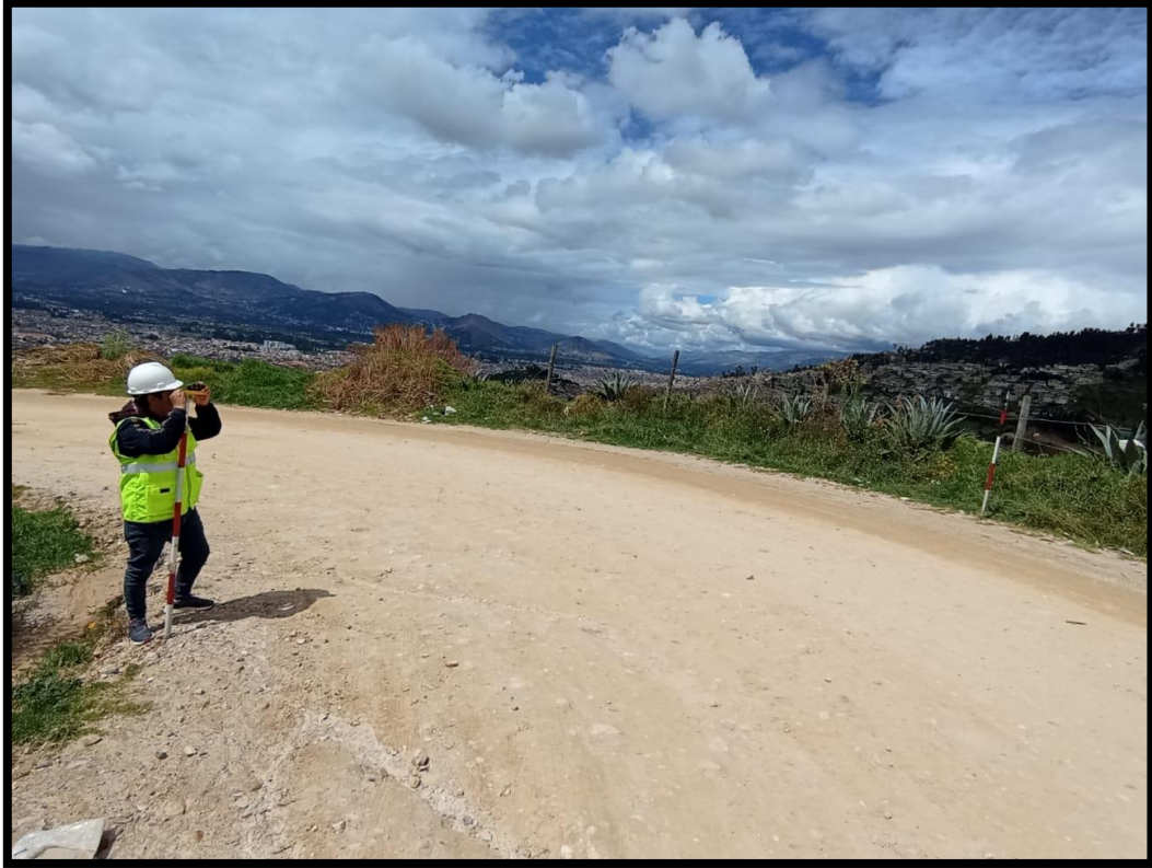
Fotografía N°11: Medida de peraltes con eclímetro
