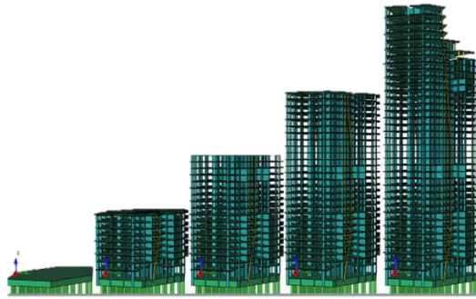
Figura 39. Construcción por etapas.
