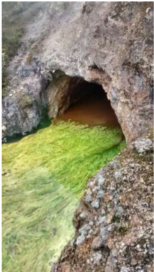
Foto 12. Pasivos mineros-socavón activo drenando agua
