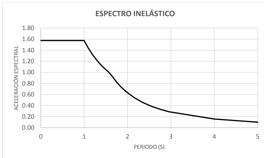
Figura 38. Espectro de respuesta objetivo construido con los parámetros de la Tabla 06.
