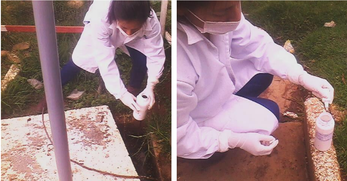
Figura 15. Toma de muestra (derecha); colocación de preservante para la conservación de la muestra (izquierda).
