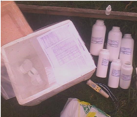
Figura 13. Materiales: cooler, frascos, hoja de custodia, multiparámetro (derecha); llenado de la hoja de custodia (izquierda).
