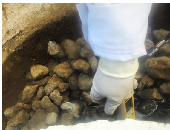
Figura 14. Medición de parámetros de campo (pH y temperatura)
