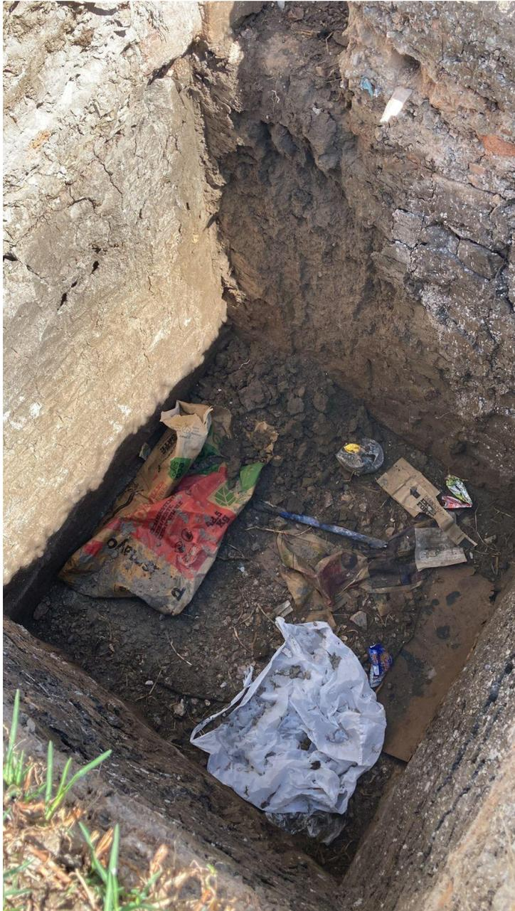
En las fotografías N° 20 y 21 se observan una excavación y una calicata encontradas en el proceso de aplicación de la encuesta en la zona “Villa Huacariz”, estas nos muestran un tipo de suelo arcilloso con presencia de material granular, el mismo que corresponde al tipo Q-A1 o depósito aluvial indicado en el “Programa de prevención y medidas de mitigación ante desastres de la ciudad de Cajamarca. Cajamarca” elaborado por INDECI.
