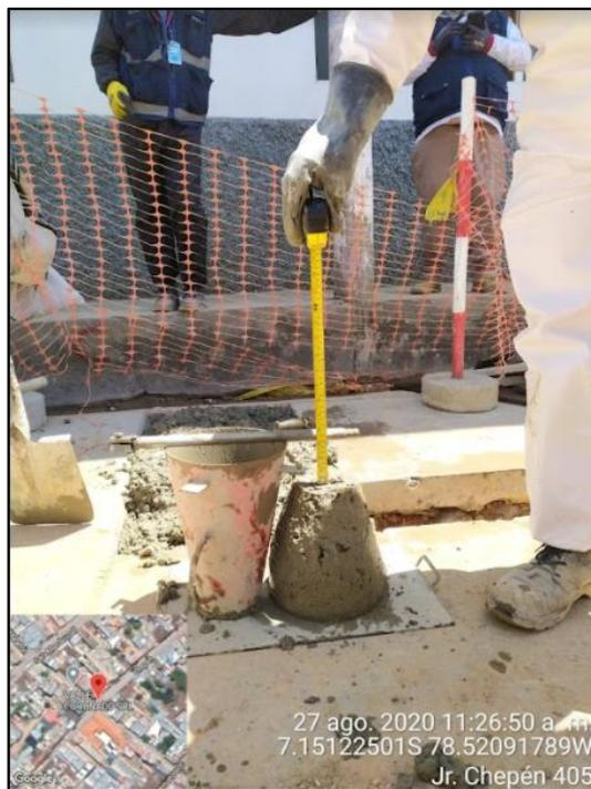
Foto 35. Medición de la consistencia de concreto.
