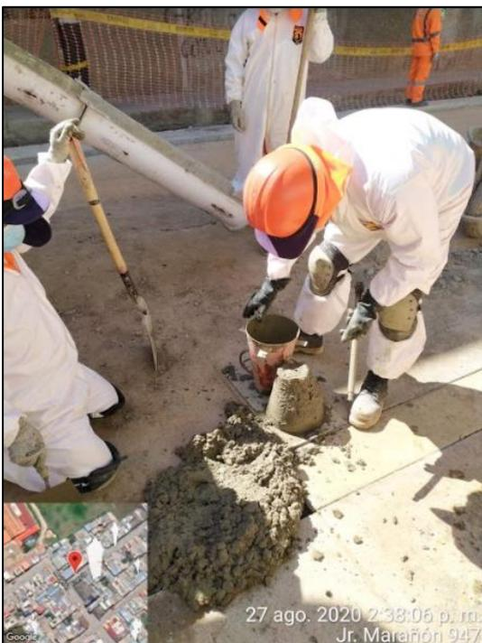
Foto 34. Desmolde del cono de Abrams una vez apisonado en 3 capas de concreto.
