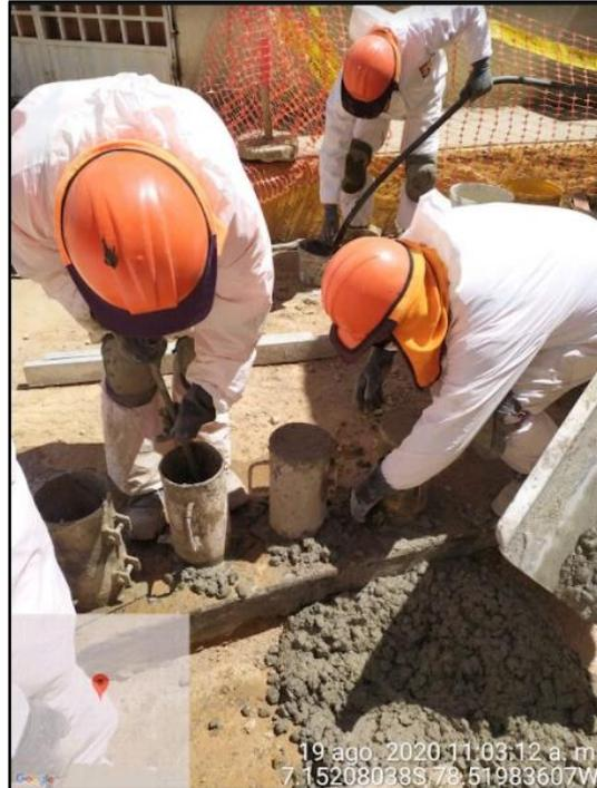
Foto 28. Elaboración del tercer espécimen de concreto.
