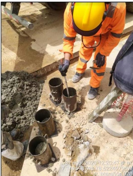
Foto 38. Elaboración de los especímenes de concreto.
