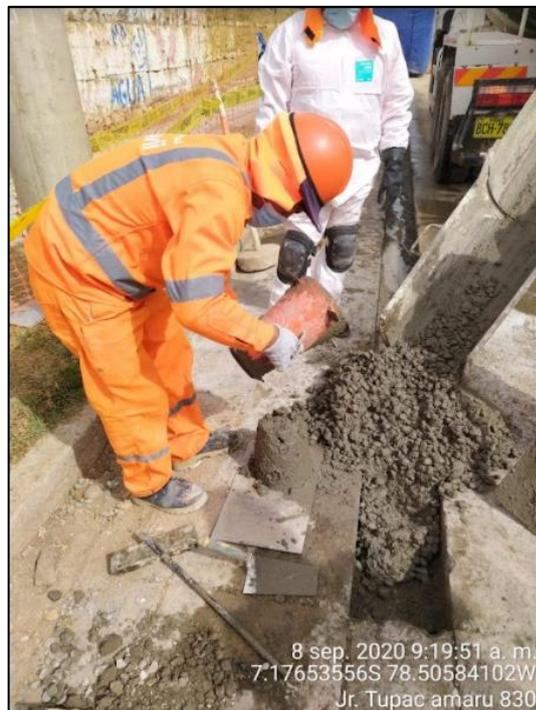
Foto 47. Desmolde del cono de Abrams.
