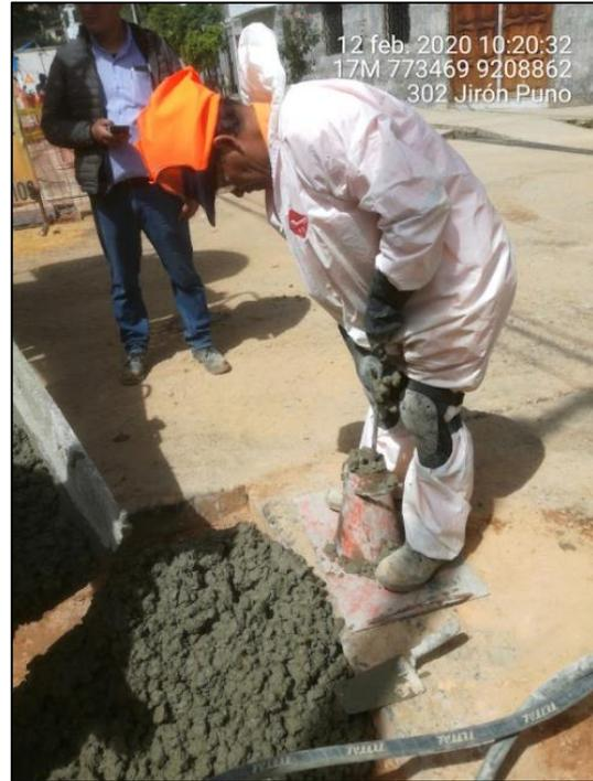
Foto 08. Ensayo de consistencia en su tercera capa.
