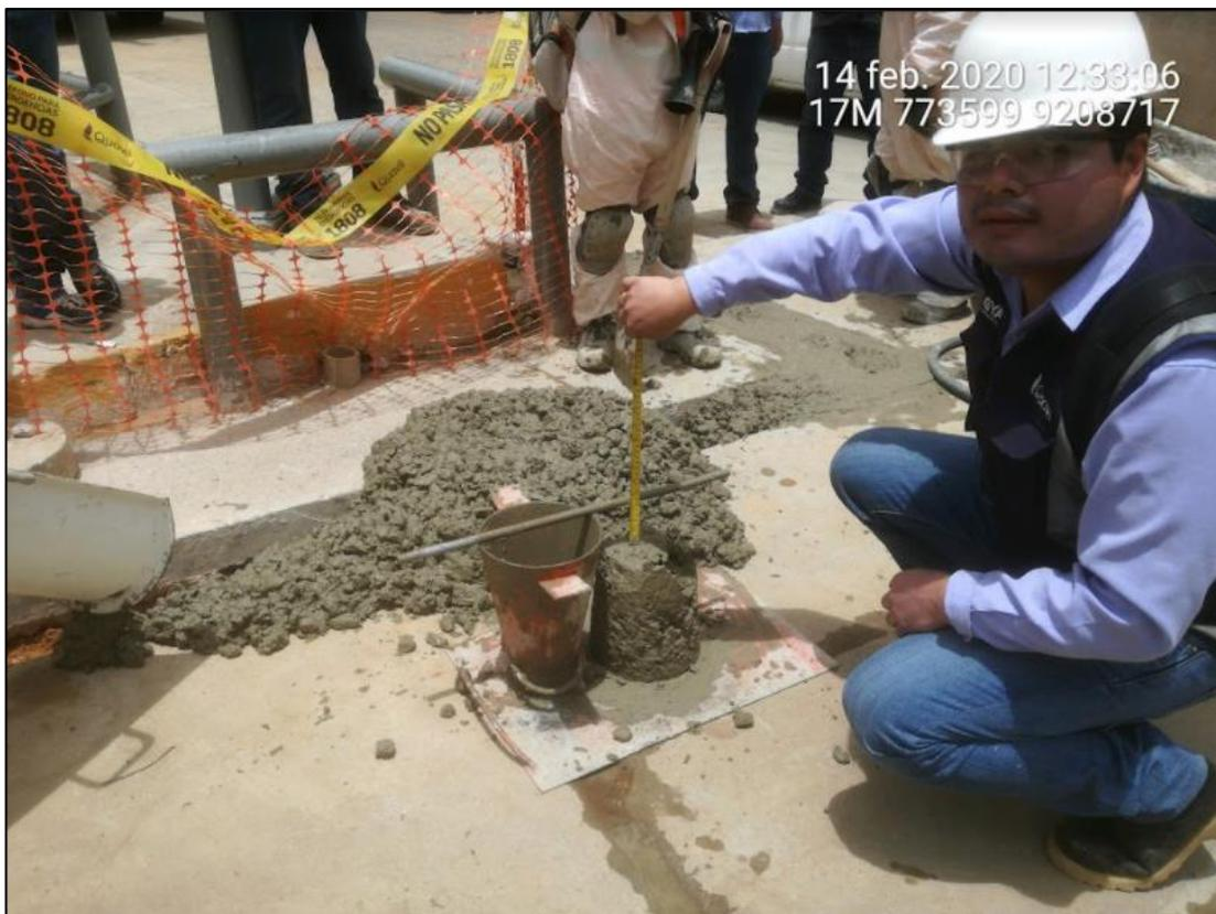
Foto 14. Medición de la consistencia del concreto.
