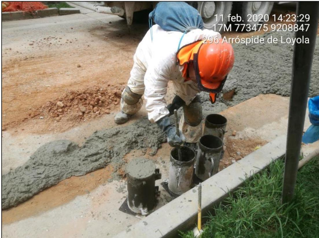
Foto 05. Apisonamiento de la primera capa del segundo espécimen de concreto.
