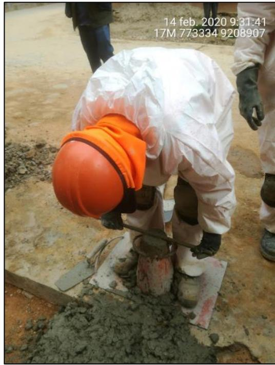
Foto 11. Culminación del ensayo de consistencia con el enrazado.
