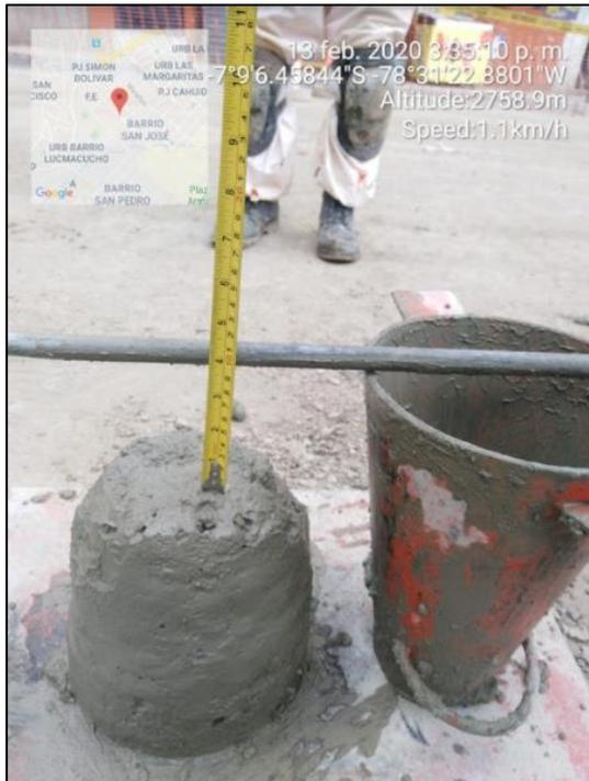
Foto 10. Medición de la consistencia, la cual nos muestra una medida de 4 pulg.
