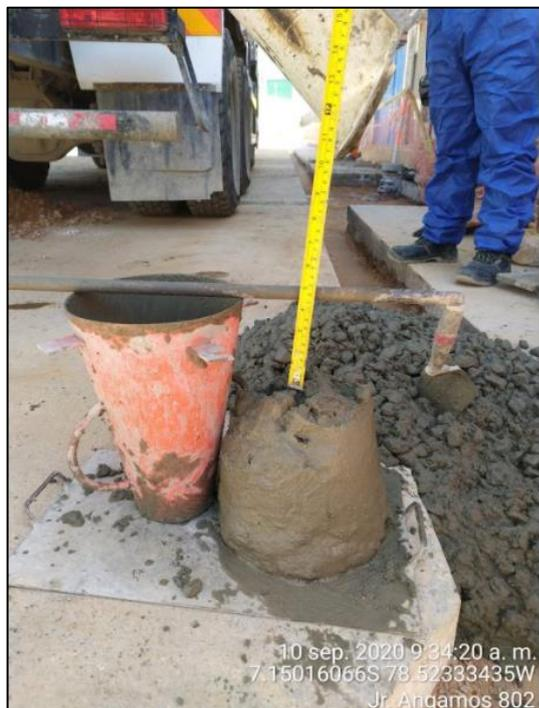
Foto 51. Determinación de la consistencia del concreto.
