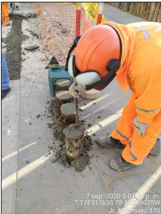
Foto 46. Apisonado de la última capa en la elaboración del cuarto espécimen de concreto.
