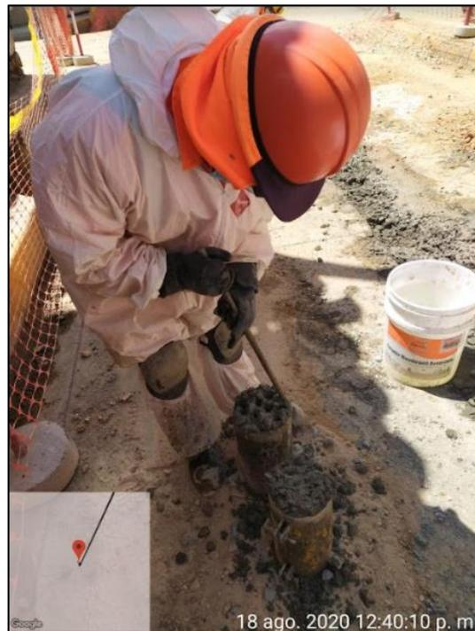
Foto 26. Apisonamiento de los especímenes de concreto en su tercera capa.
