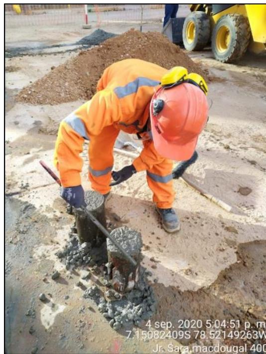
Foto 43. Enrazado de los especímenes de concreto.
