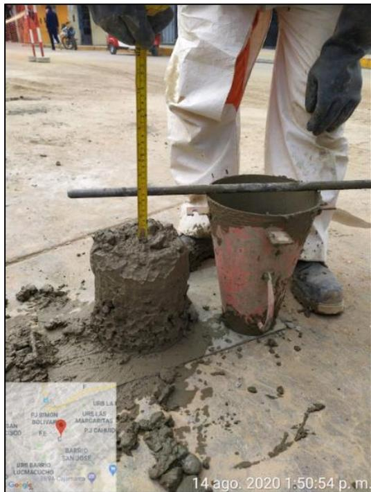
Foto 21. Medición de la consistencia del concreto.
