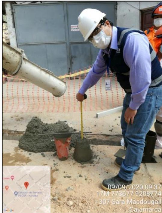
Foto 49. Determinación de la consistencia del concreto.
