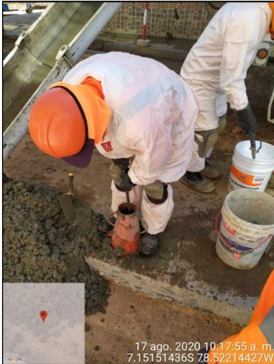
Foto 23. Apisonamiento de la segunda capa para la prueba de consistencia.
