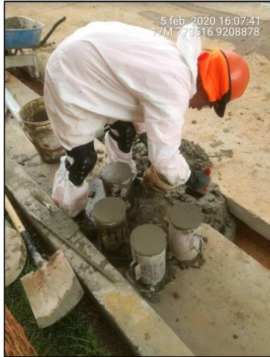
Foto 02. Culminación de la elaboración de los especímenes de concreto.
