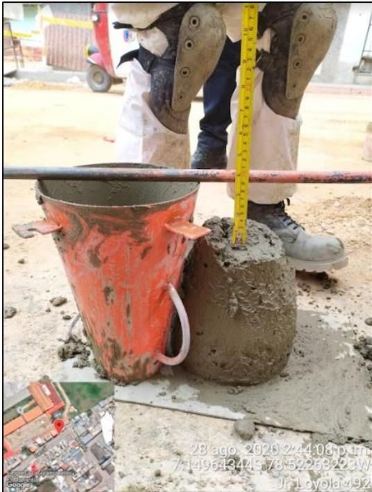
Foto 36. Determinación de la consistencia del concreto.
