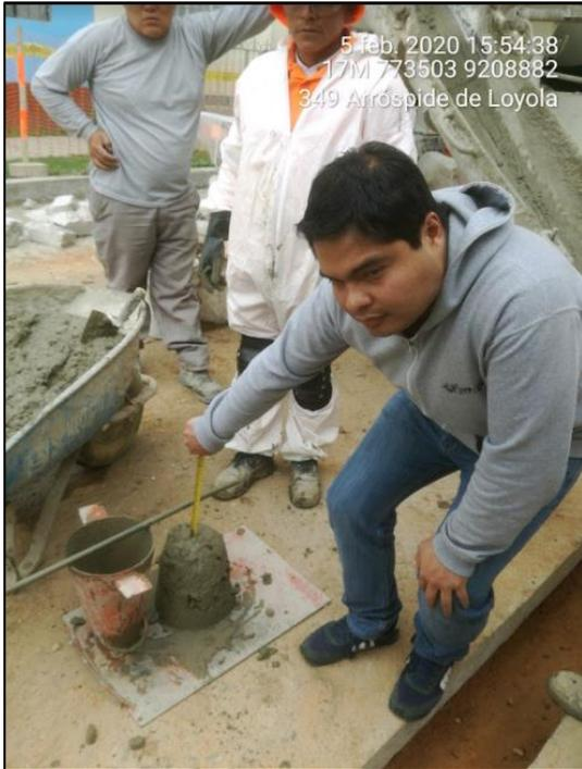
Foto 01. Realizando la medición de la consistencia.
