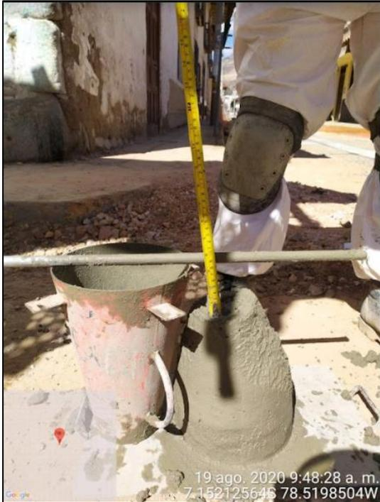
Foto 27. Medición de la consistencia del concreto.
