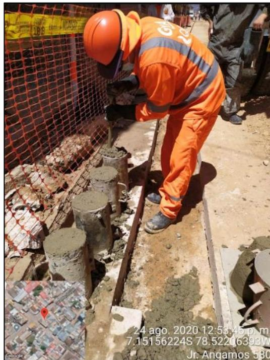
Foto 31. Culminación del cuarto espécimen de concreto.
