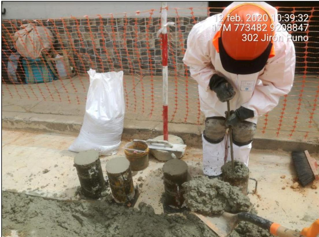
Foto 09. Apisonamiento de la tercera capa en la elaboración del cuarto espécimen de concreto.
