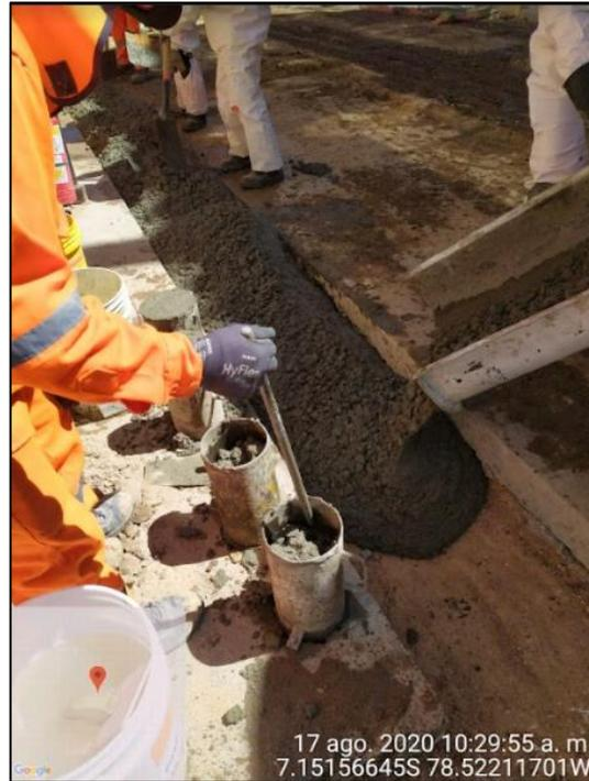
Foto 24. Apisonamiento de la segunda capa del tercer y cuarto espécimen de concreto.
