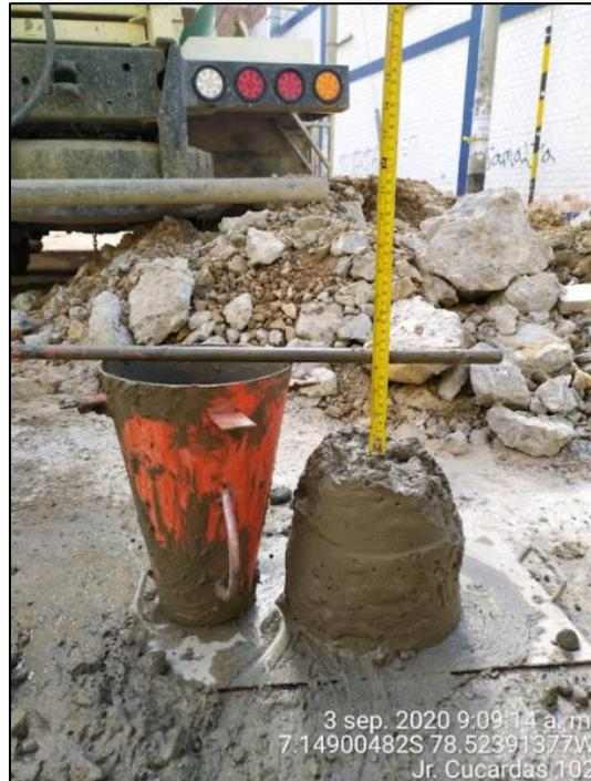
Foto 41. Medición de la consistencia del concreto.
