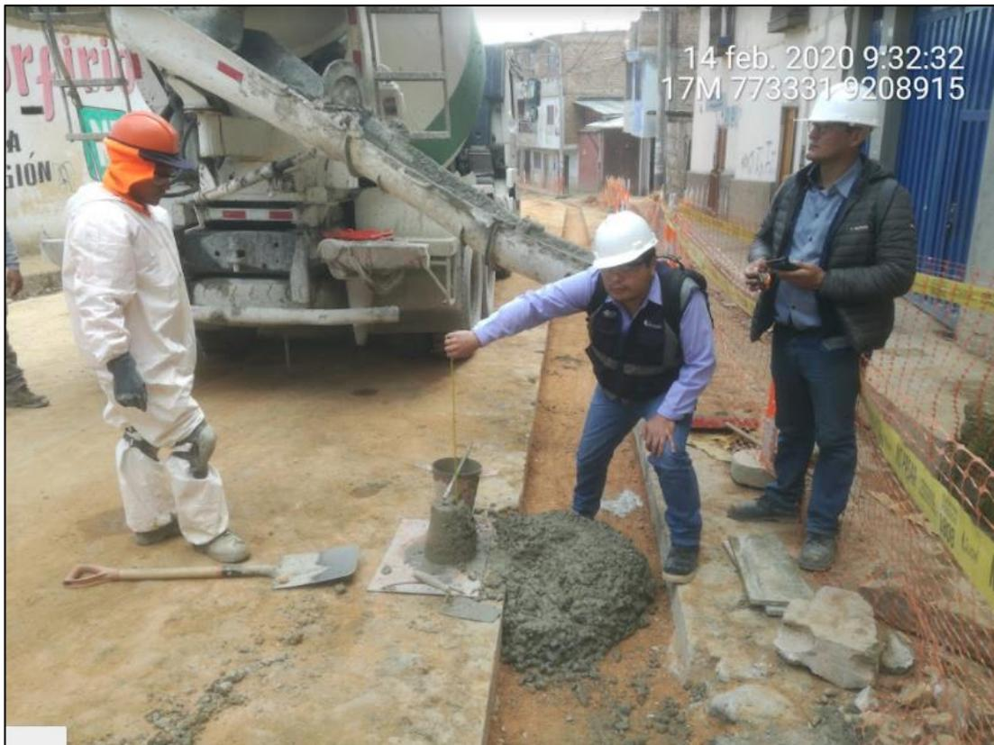
Foto 12. Realizando la medición de la consistencia del concreto.
