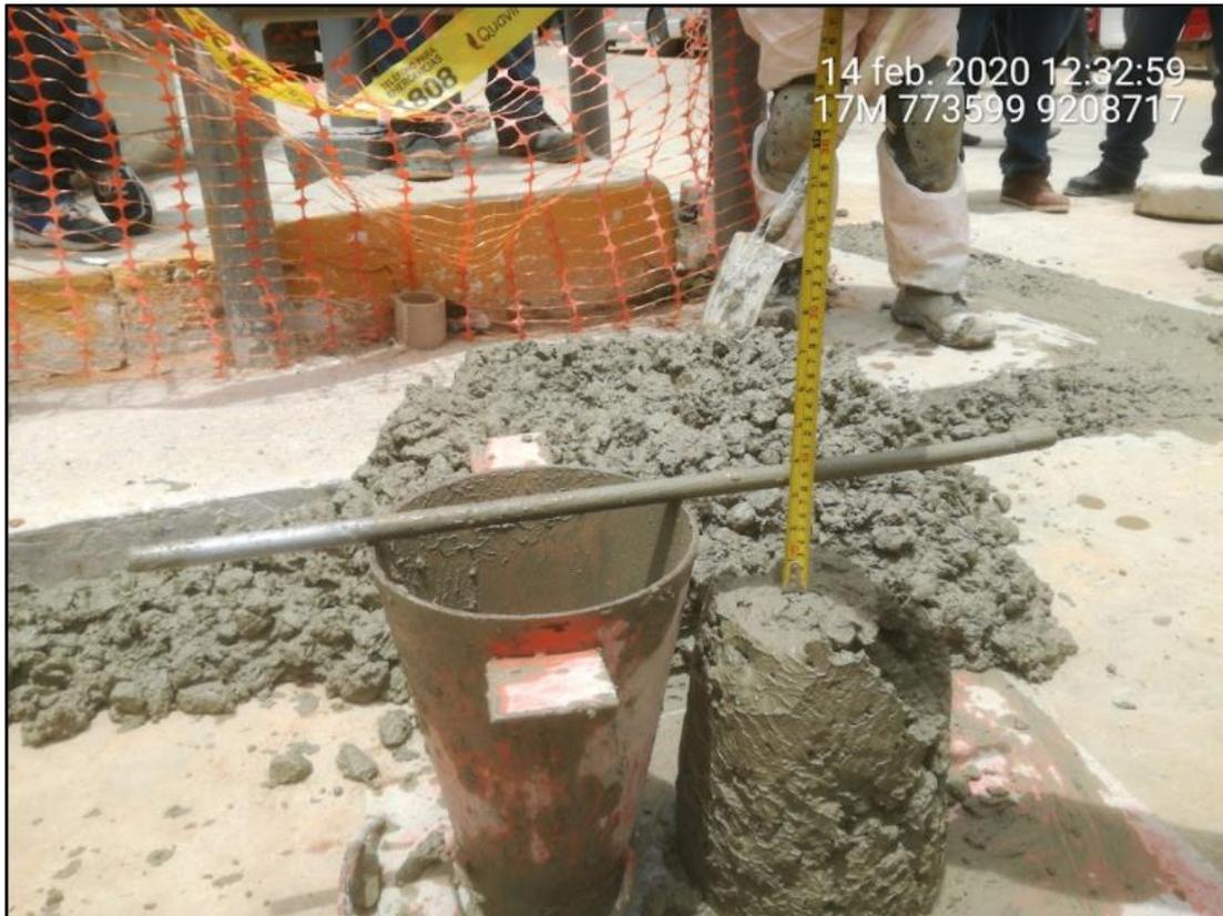
Foto 13. Medición de la consistencia del concreto.
