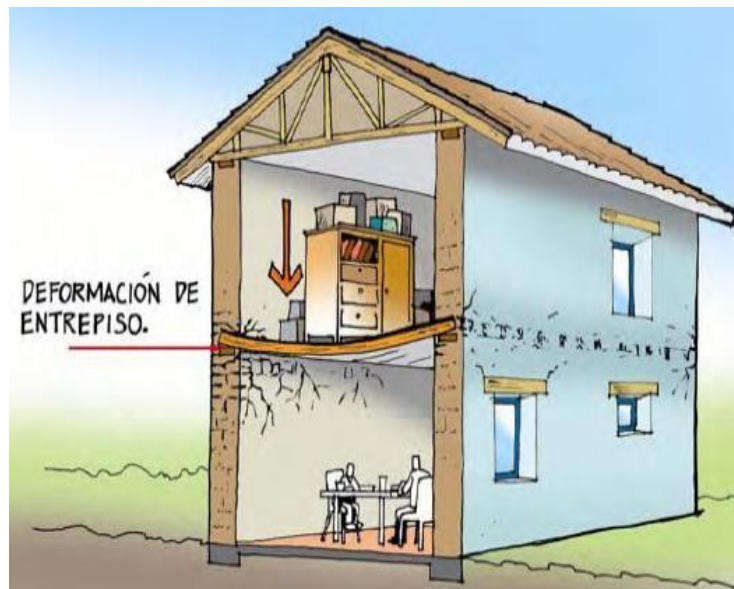
FIGURA 13. Deformación de entrepiso en viviendas de adobe
