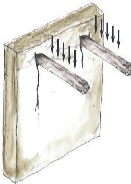
FIGURA 11. Fallas por punzonamiento en edificaciones de tapial.
