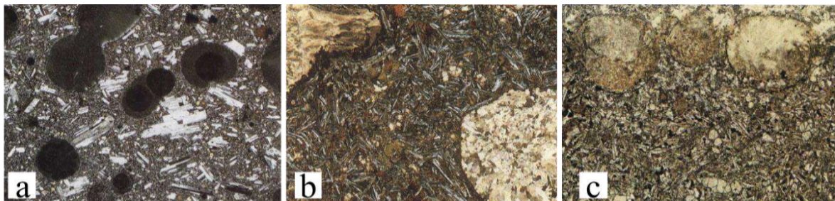
Figura 17. a) Textura vesicular en roca volcánica formado por la expansión del gas que ha dejado grandes cavidades subredondeadas; b) textura amigdaloides, donde se observa que las vacuolas ha sido rellenas por carbonatos de calcio y minerales arcillosos de alteración;
