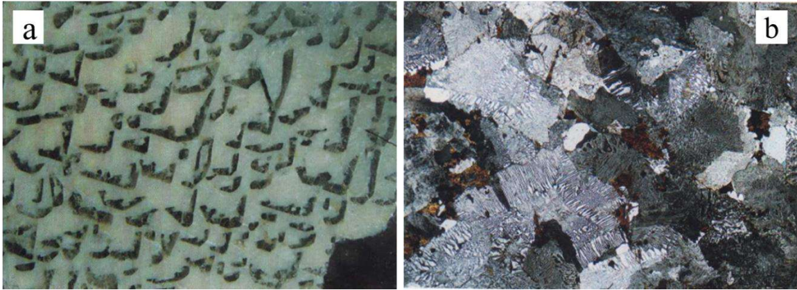
Figura 12. a) Texturas de intercrecimiento grafica de un granito; b) texturas micrográficas y granofíricas de un granito (Mackenzie et al., 1996).
