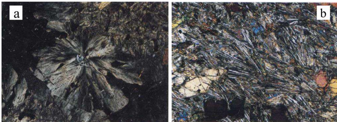
Figura 14. Texturas radiales, a) esferulito de una riolita; b) dolerita variolítica con olivino, (Mackenzie et al., 1996).
