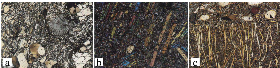
Figura 10. Texturas orientadas, dirigidas y alineadas, a). textura traquítica en una roca traquita; b) textura traquitoide en una dolerita olivínica; c) textura de crecimiento paralelo (Mackenzie et al., 1996).
