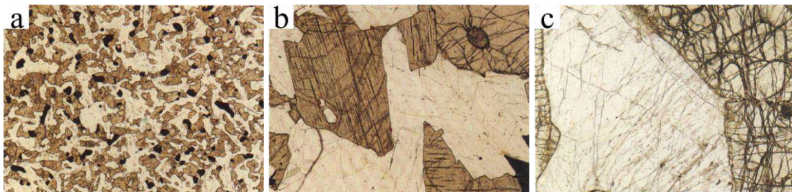
Figura 8. a) Tamaño absoluto de los cristales con un aumento de 27X, gabro de grano fino; b) gabro de grano medio; c) gabro de grano grueso (Mackenzie et al., 1996).
