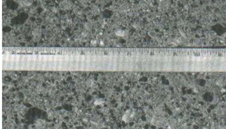
Fotografía N°11: Vista típica de pulimiento de agregados
