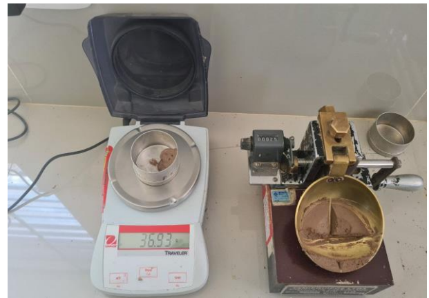
Fotografía 16: Elaboración del ensayo Límite líquido
