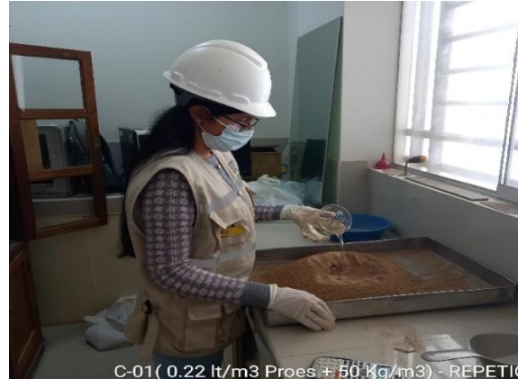
Fotografía 30: se vierte la dilución sobre la combinación suelo-cemento.
