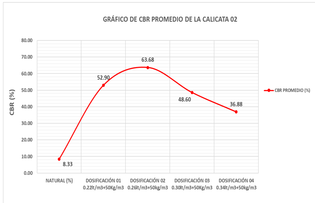
Figura 14. CBR promedio de la calicata 2
