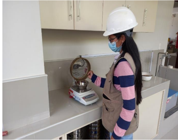
Fotografía 18: Se pesa las fracciones retenidas en el tamiz.
