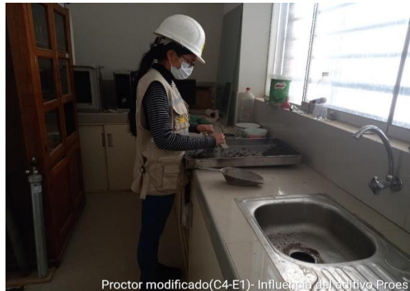
Fotografía 20: Elaboración del ensayo Proctor modificado, en la cual se está enrasando el molde
