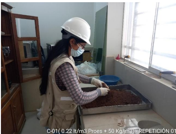
Fotografía 31: se mezcla hasta obtener una humedad uniforme
