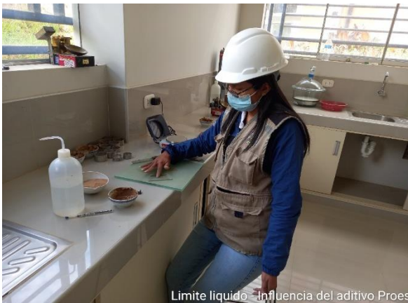
Fotografía 15: Elaboración del ensayo de Límite plástico.
