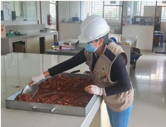
Fotografía 13: Cuarteo del espécimen de ensayo para el contenido de humedad.
