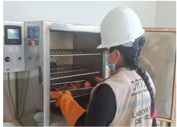
Fotografía 14: Secado de la muestra para determinar el contenido de humedad.
