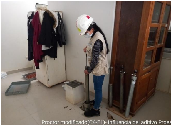
Fotografía 19: Elaboración del ensayo Proctor modificado, en la cual se está realizando la compactación
