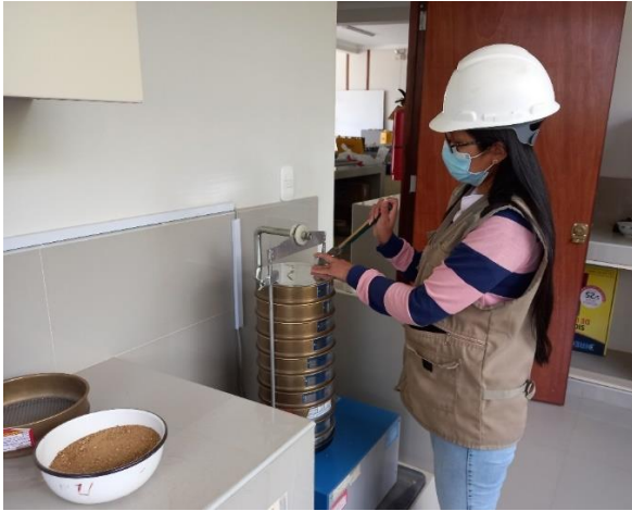
Fotografía 17: Elaboración del ensayo granulométrico, en la cual se está realizando el tamizado
