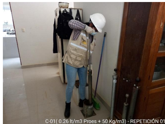
Fotografía 32: se realiza la compactación del espécimen de ensayo mezclado con el aditivo Proes y el aditivo sólido
