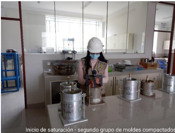
Inicio de saturación - segundo grupo de moldes compactados
