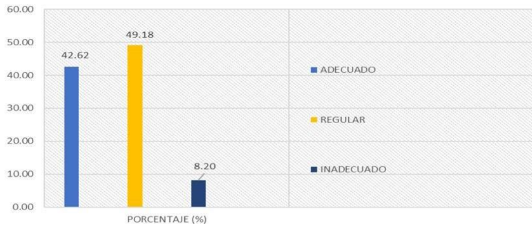
FIGURA 6: Estado de los micromedidores de agua potable en viviendas.
