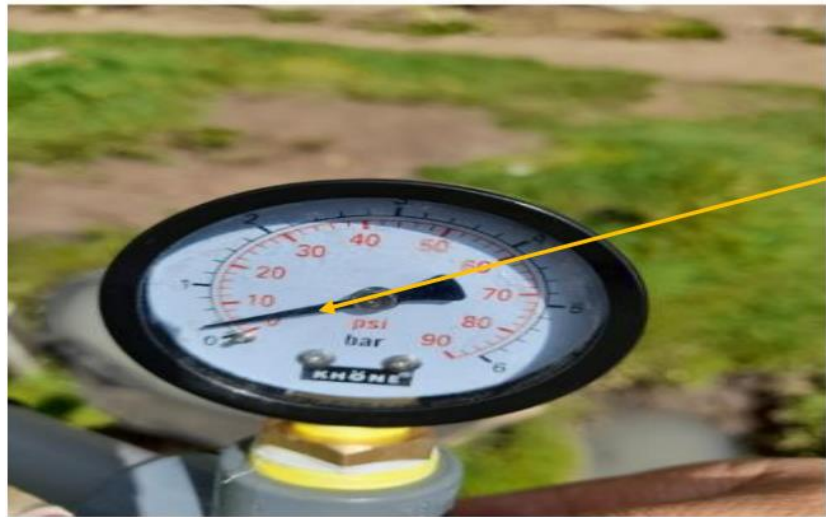
Fotografía 29 Lectura de presión dinámica mediante el uso de manómetro
