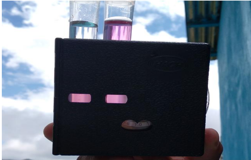
Fotografía 23 Evaluación de cloro residual en la primera vivienda
