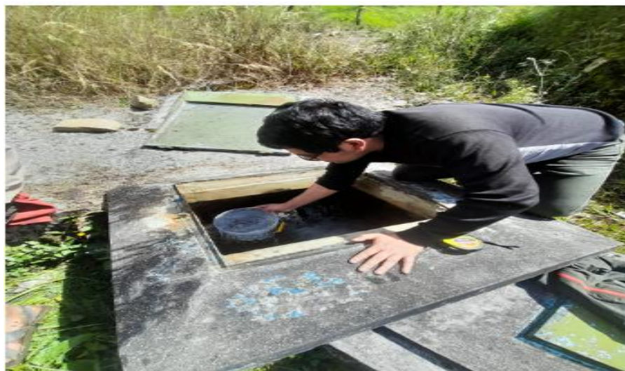
Fotografía 21 Aforo en la captacion "Alto Mirador"
