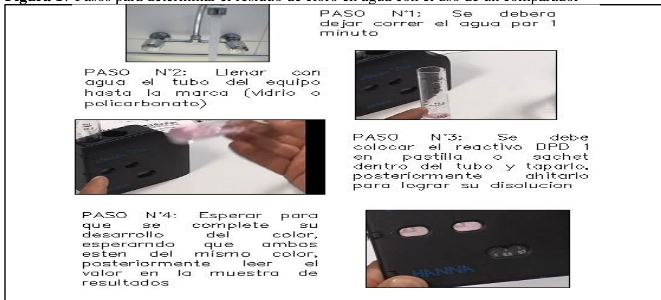
Figura 17 Pasos para determinar el residuo de cloro en agua con el uso de un comparador
