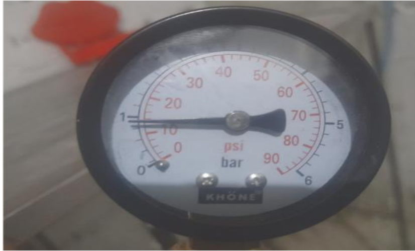
Fotografía 29 Lectura de presión dinámica mediante el uso de manómetro
