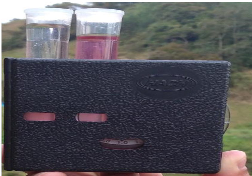
Fotografía 23 Evaluación de cloro residual en la primera vivienda
