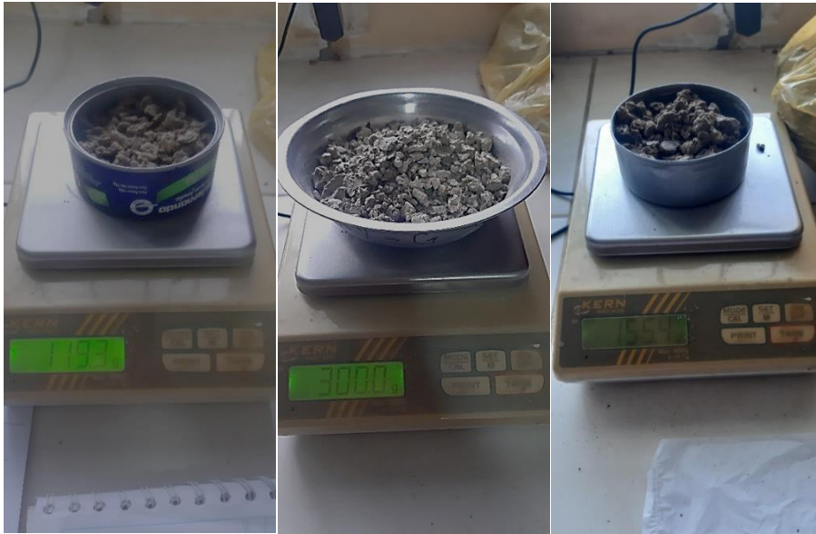
Fotografía N°05 Ensayo de contenido de humedad para C-6, C-8 Y C-10
