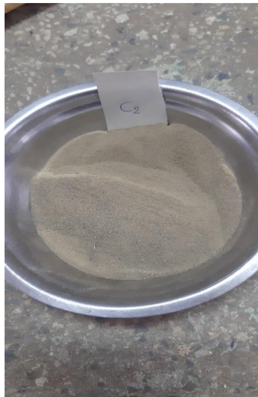
Fotografía N° 20 Material que pasa el Tamiz N°40 para limite Líquido y Plástico
