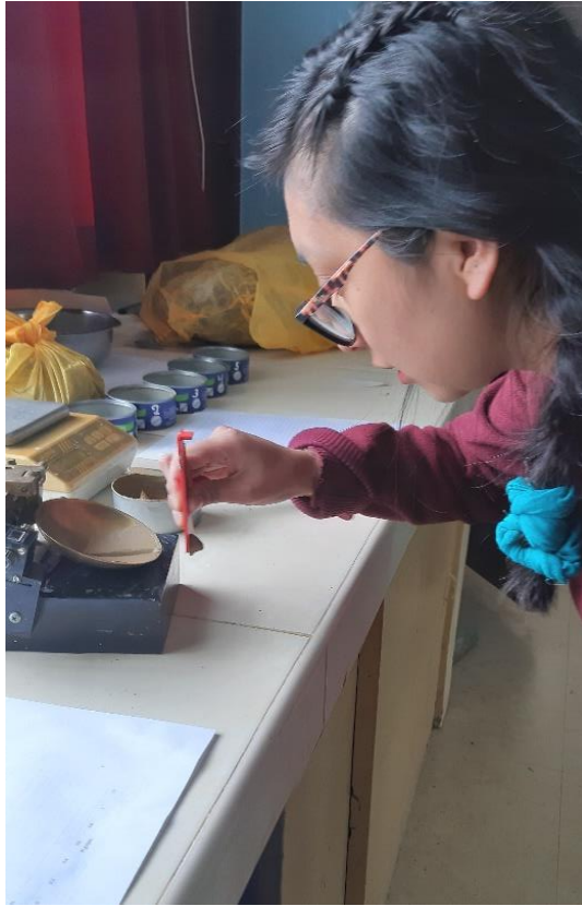
Fotografía N°21 Ejecución del ensayo de Límite Líquido
