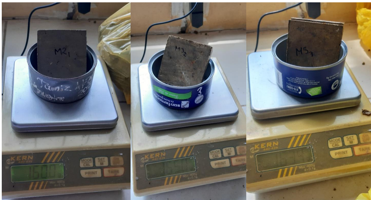
Fotografía N° 17 Peso de especímenes secos de C-10, para Contenido de humedad
