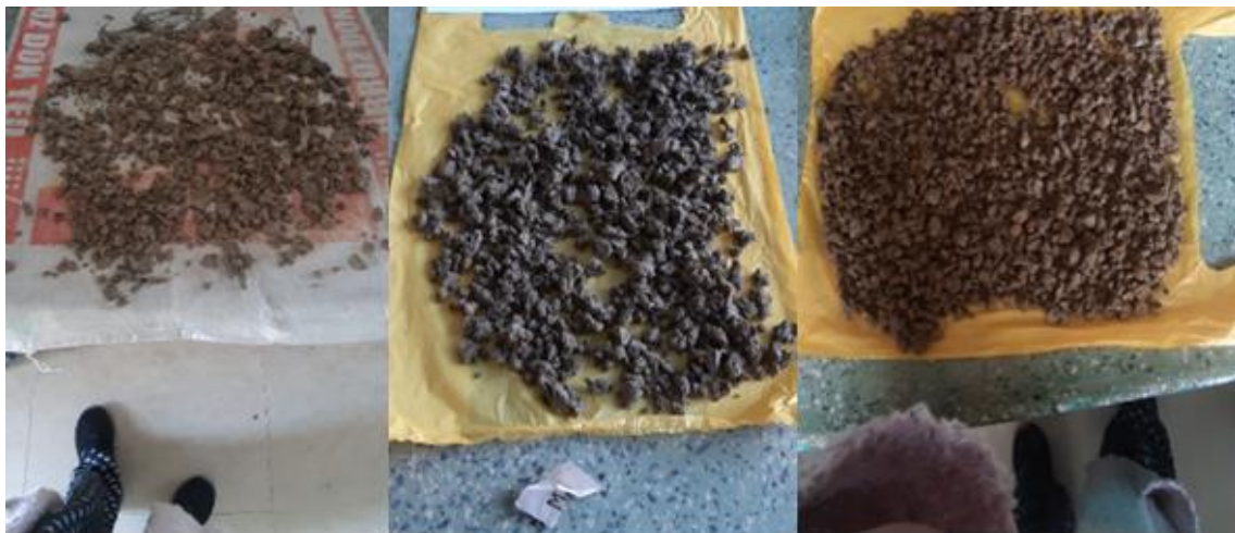
Fotografía N°04 Muestras de Suelo de C-6, C-8 Y C-10 para ensayo Granulométrico
