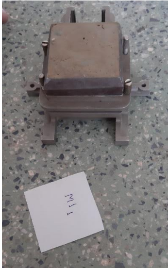
Fotografía N°07 Muestra M1 1 Debidamente colocada en la caja de corte
