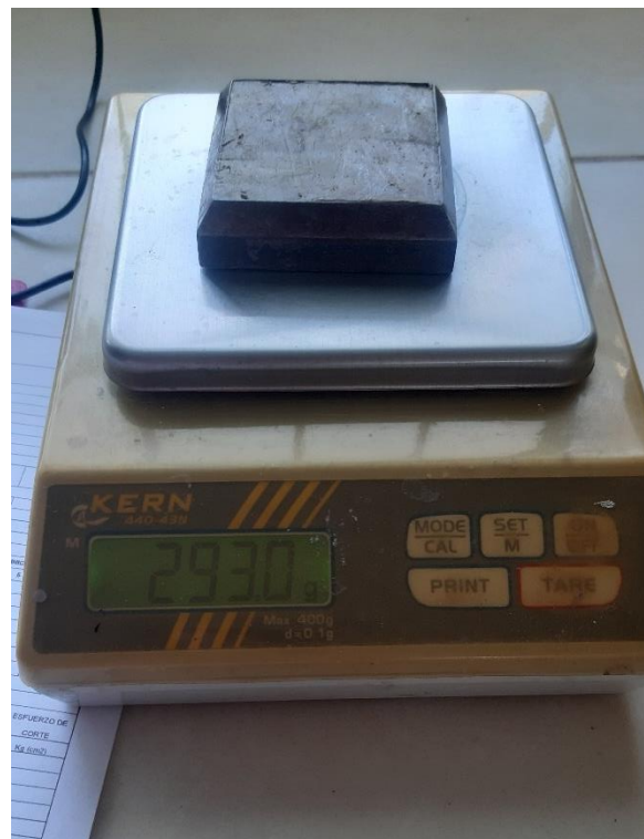
Fotografía N°08 Peso del espécimen para determinar contenido de humedad
