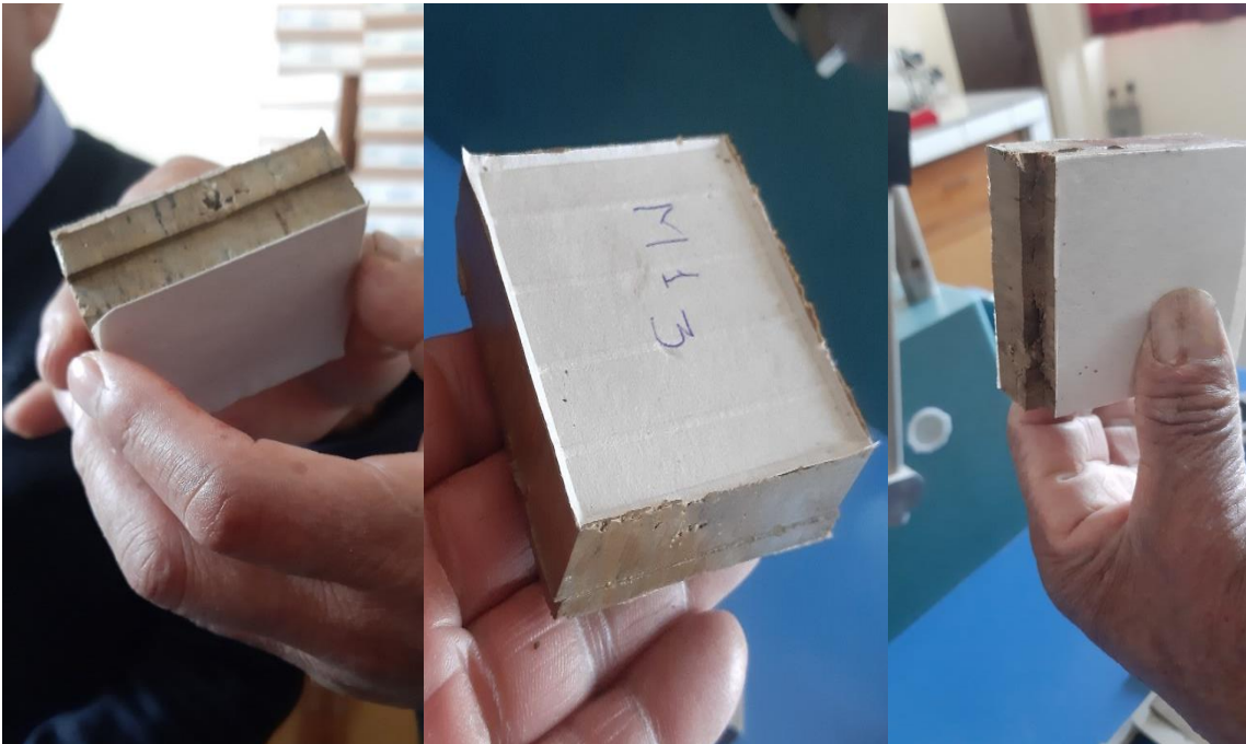
Fotografía N°10 Especímenes después de realizado el Ensayo de Corte directo
