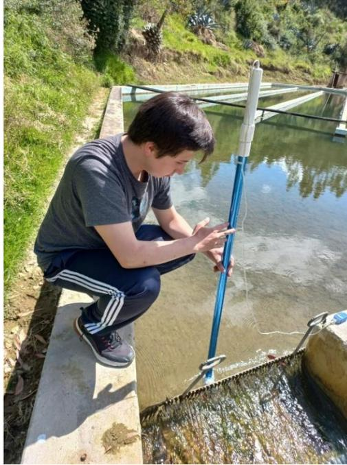
Figura 79. Toma de datos de las velocidades a la salida de la estructura.
