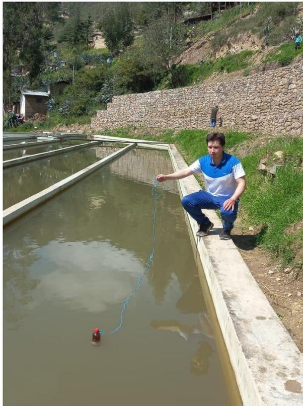
Figura 82. Medición de la velocidad mediante el método del flotador en la sección 1
