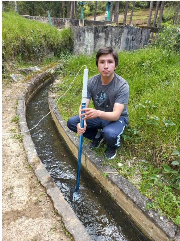
Figura 80. Toma de datos del caudal de entrada para la calibración del modelo.
