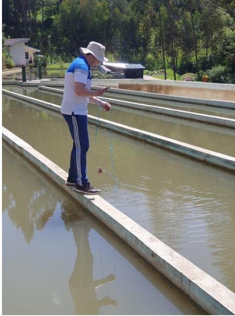
Figura 83. Medición de la velocidad mediante el método del flotador en la sección 2
