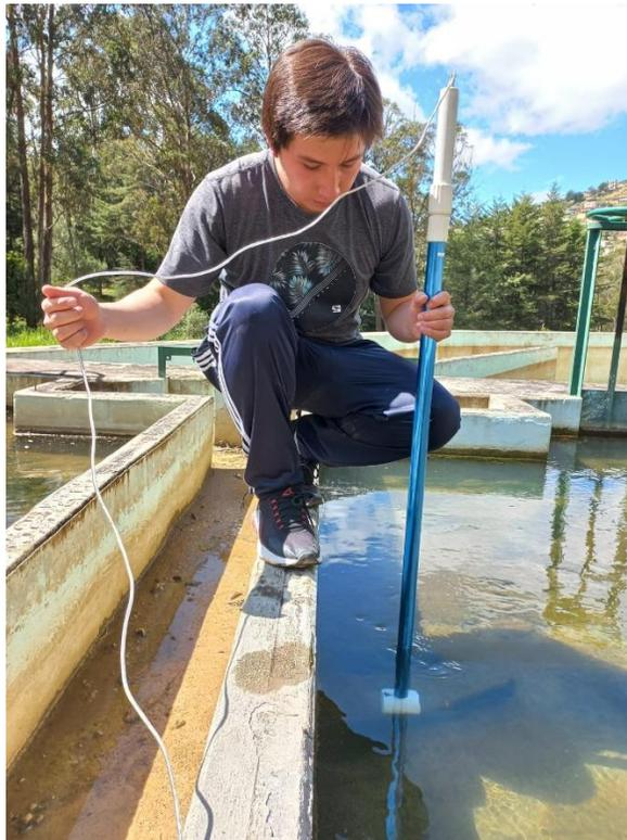
Figura 78. Toma de datos de las velocidades a la entrada de la estructura.
