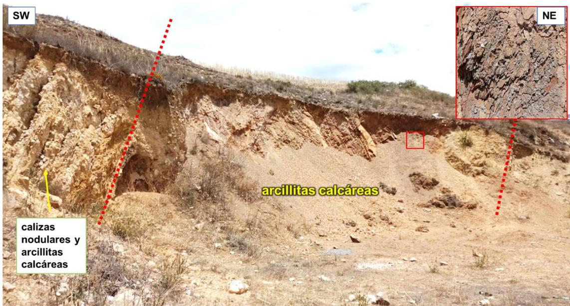
Fotografía 23. Presencia de 15 m de arcillitas calcáreas, seguido de una intercalación de calizas nodulares y las mismas arcillitas calcáreas.
