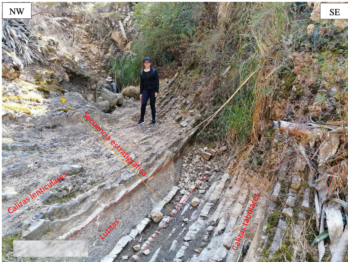
Figura 3.16. Formación Pariatambo, compuesto por secuencia de calizas: Nodulares y lenticulares, con intercalaciones lutitas bituminosas de espesor: 0.10 m. 0.15 m. Zona Puyllucana.
