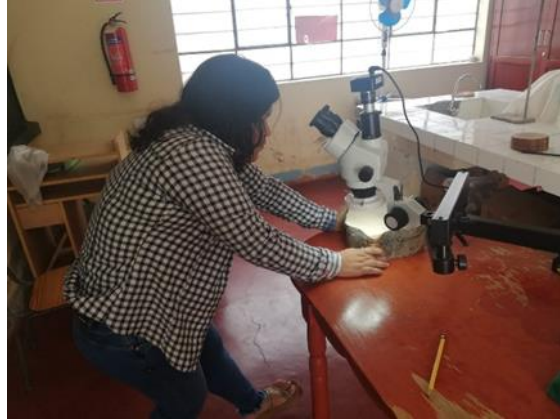
Foto 14. Identificación de anillos en muestras de rodajas con Estereoscopio
