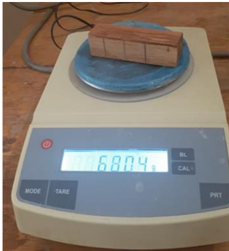
Foto 17. Peso húmedo de probetas
