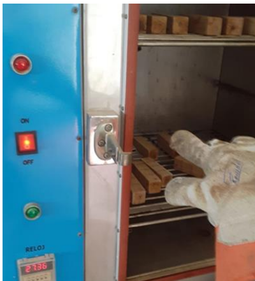
Foto 19. Retirado de probetas de estufa
