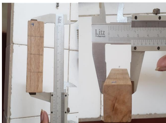
Foto 21. Medición de las aristas de las probetas secas con ayuda del vernier
