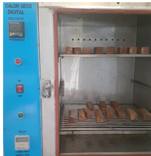
Foto 18. Secado de probetas en estufa
