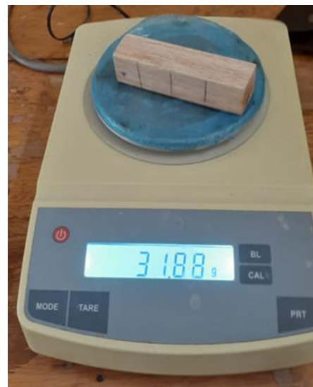
Foto 20. Peso seco de probetas
