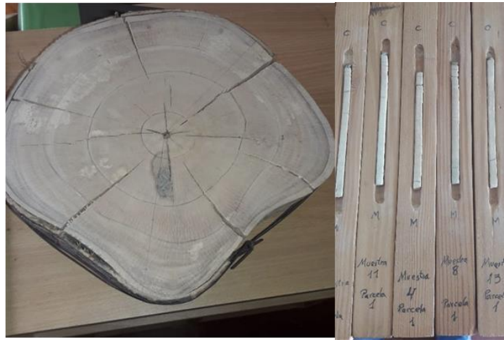
Foto 12. Identificación de anillos de crecimiento
