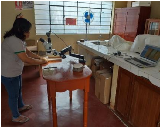
Foto 13. Identificación de anillos en muestras de tarugos con Estereoscopio
