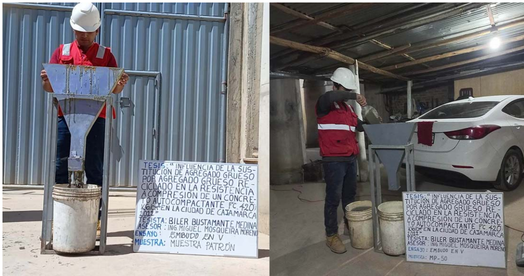
Figura N° 48: Realización de ensayo de embudo en V
