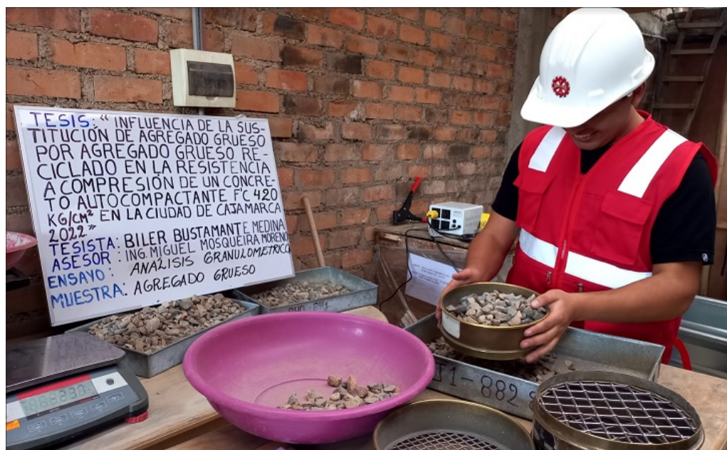
Figura N° 30: Tamizado de agregados para análisis granulométrico
