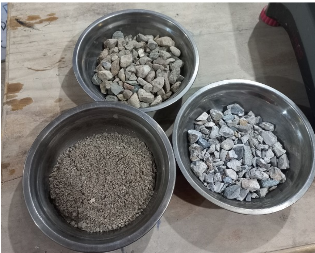
Figura N° 38: Muestras de agregado fino, grueso y grueso reciclado obtenido mediante trituración de fragmento de concreto demolido
