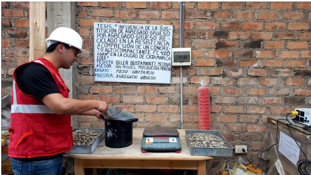
Figura N° 32: Peso unitario suelto seco de agregado grueso
