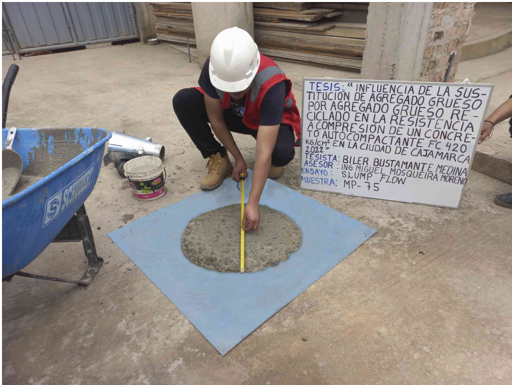
Figura N° 46: Ensayo de extensión de flujo (muestra MP-75)
