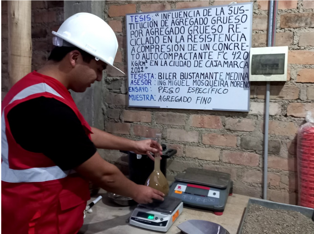
Figura N° 35: Peso específico de agregado fino
