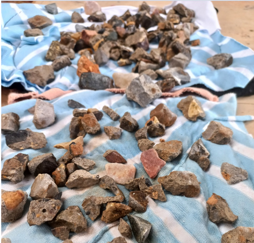
Figura N° 37: Fragmentos triturados de concreto demolido en condición saturado superficialmente seco (SSS)
