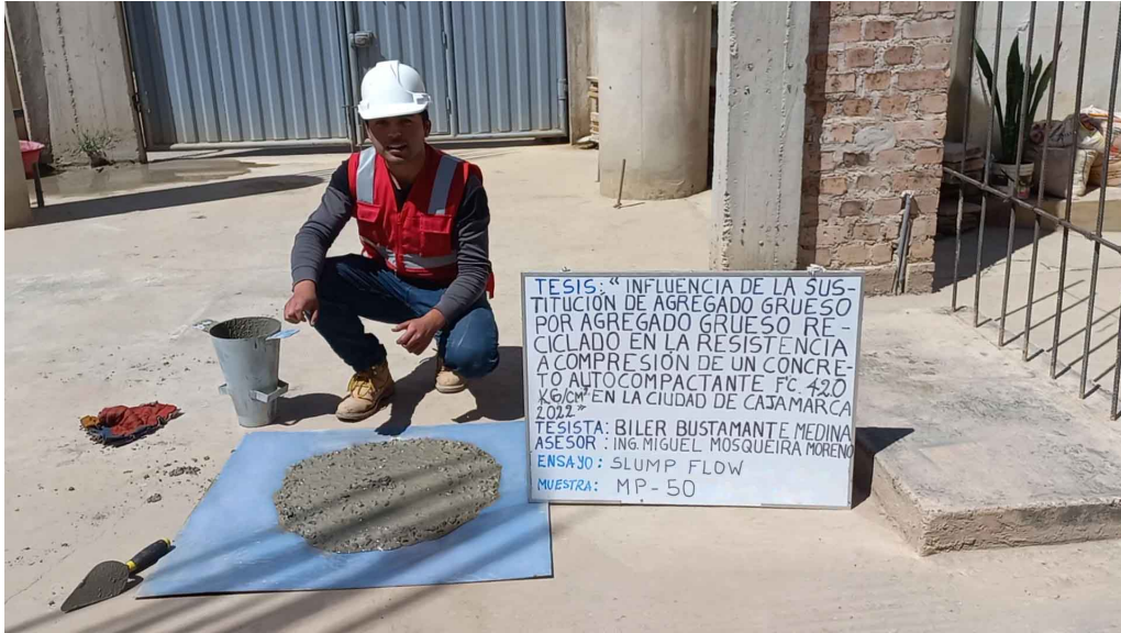
Figura N° 45: Ensayo de extensión de flujo (muestra MP-50)
