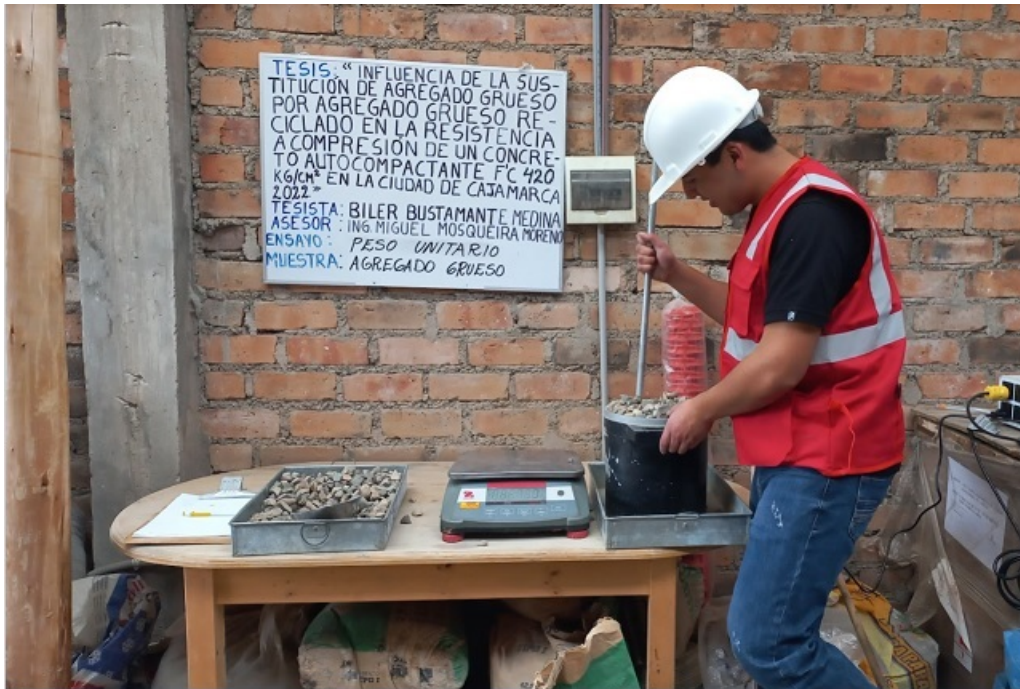
Figura N° 33: Peso unitario compactado de agregado grueso
