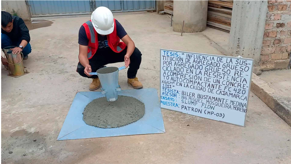
Figura N° 43: Ensayo de extensión de flujo (muestra PATRON)
