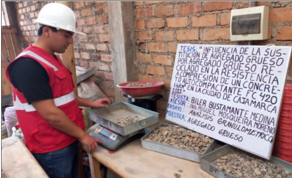
Figura N° 31: Análisis granulométrico de agregado grueso
