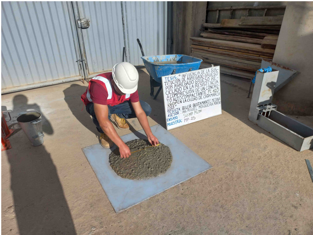
Figura N° 44: Ensayo de extensión de flujo (muestra MP-25)
