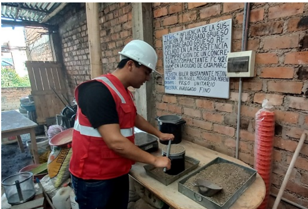
Figura N° 34: Peso unitario suelto seco de agregado fino
