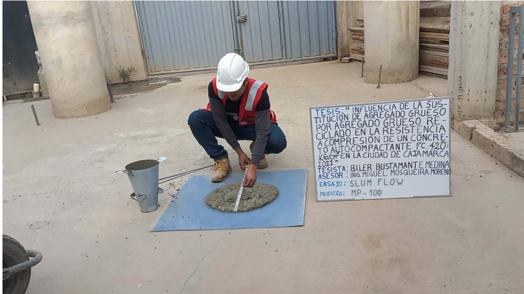
Figura N° 47: Ensayo de extensión de flujo (muestra MP-100)
