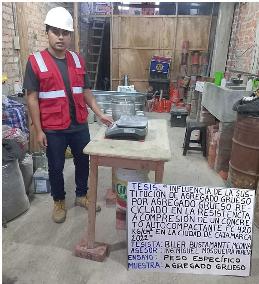
Figura N° 36: Peso específico de agregado grueso
