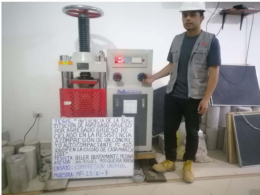
Figura N° 50: Rotura de probetas a 7 días de edad
