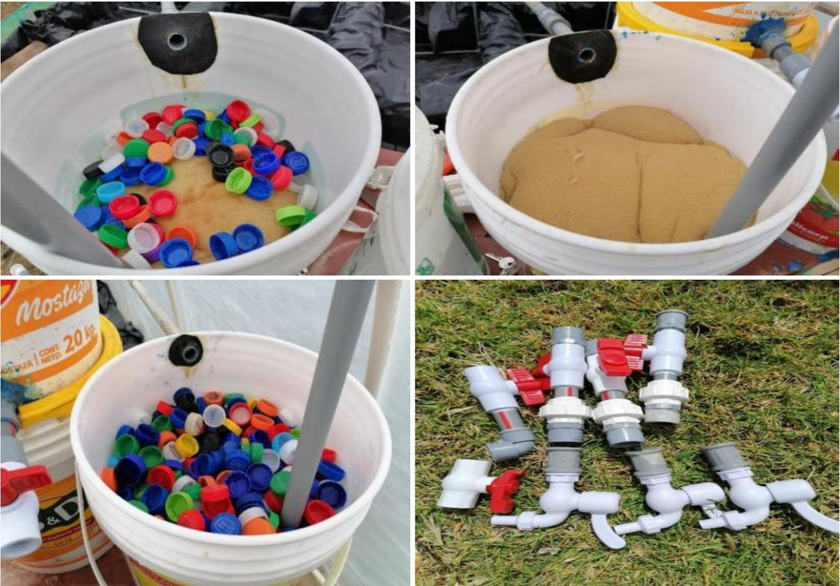
**Foto 4.** Agregando los sustratos a los biofiltros (T1, T2 y T3) en donde se van albergaron las bacterias nitrificantes.
